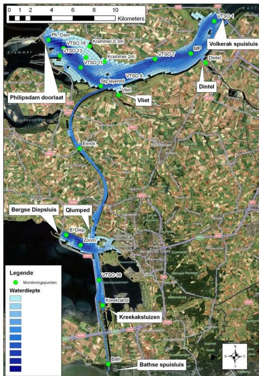
Figuur 18: Delft3D grid van het Volkerak-Zoommeer met daarin de modelranden en monitoringpunten voor tijdreeksen aangegeven.
