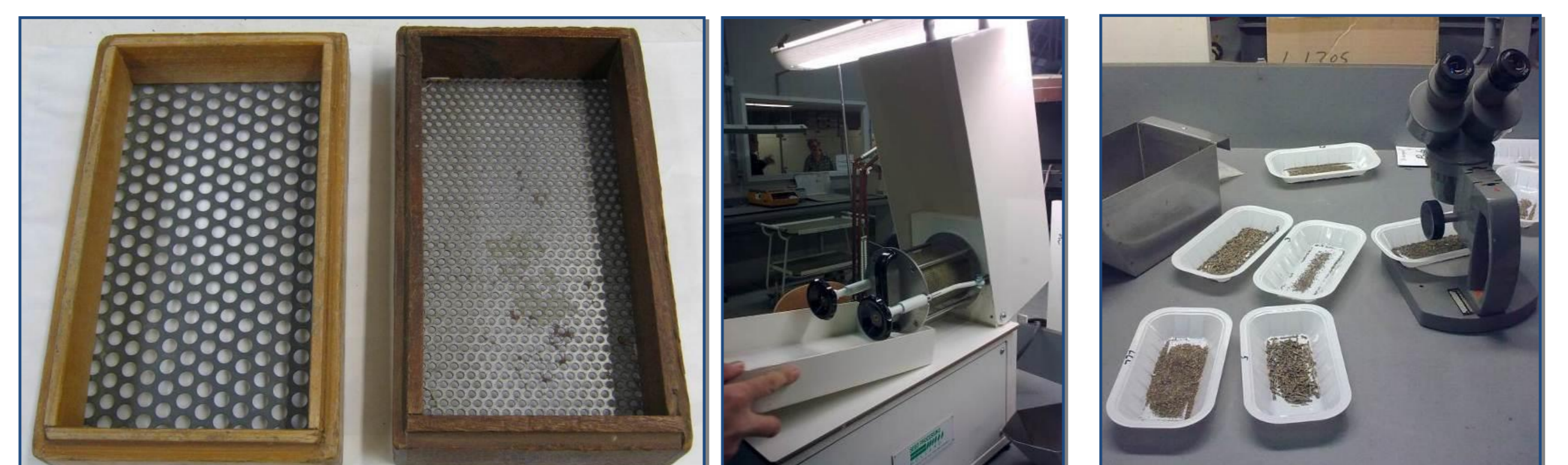
Figuur 8. Verschillende zeven, een borstelmachine en opgeschoond zaad
