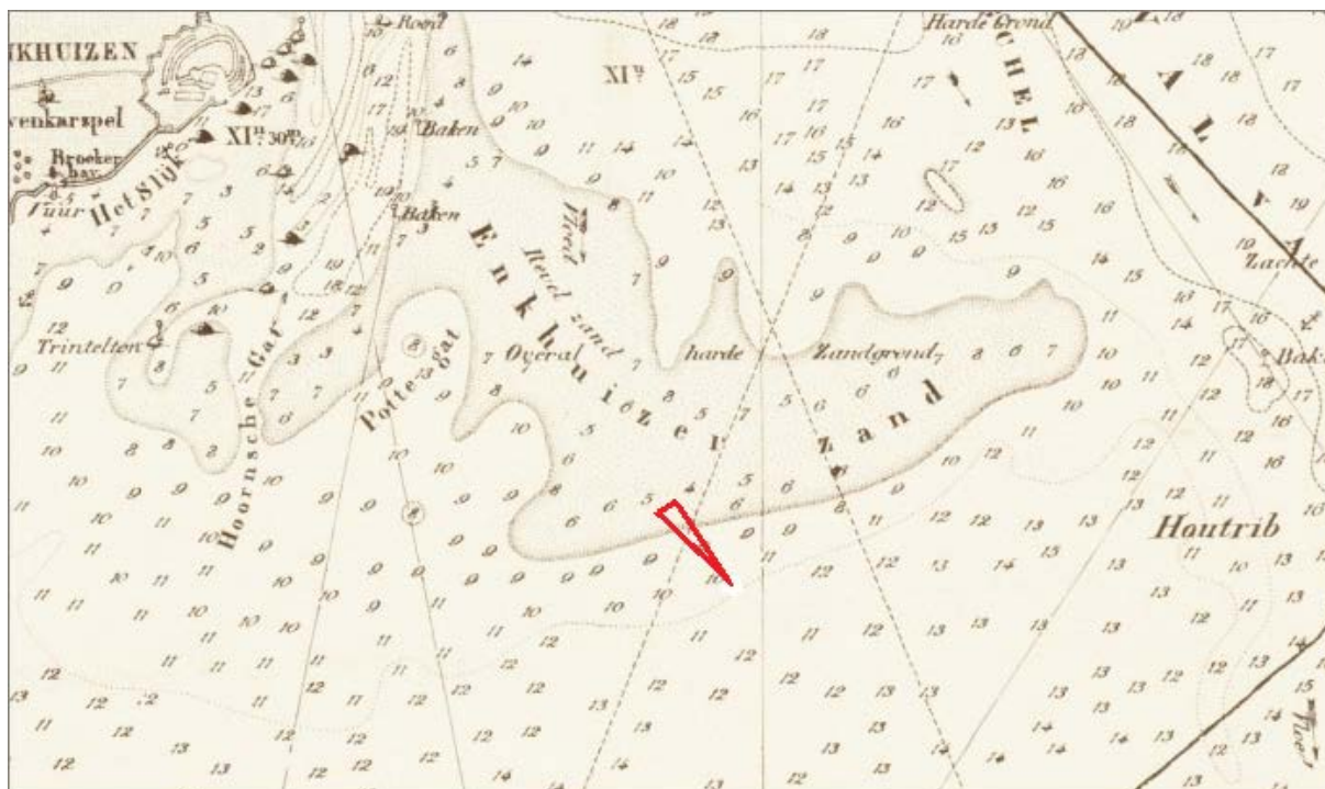
Afbeelding 5.2. Uitsnede uit een kaart uit 1852-1859 van Hulst van Keulen. De diepten zijn weergegeven in Amsterdamse voeten (1 Amsterdamse voet is 0,286 m) ten opzicht van gemiddeld laag water (GLW). 0 m GLW komt overeen met ongeveer 0,5 m –NAP.
