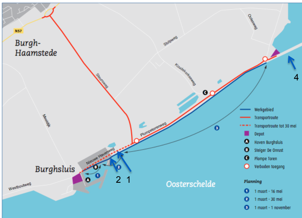
Kaart 2 Detail Burghsluis, onderzoekslocaties aangegeven met blauwe pijlen. 1: Proefvlak Eco-Hillblok; 2: Basalt; 4: Referentie eco-toplaag van lava. (Bron oorspronkelijke afbeelding: Projectbureau Zeeweringen).
