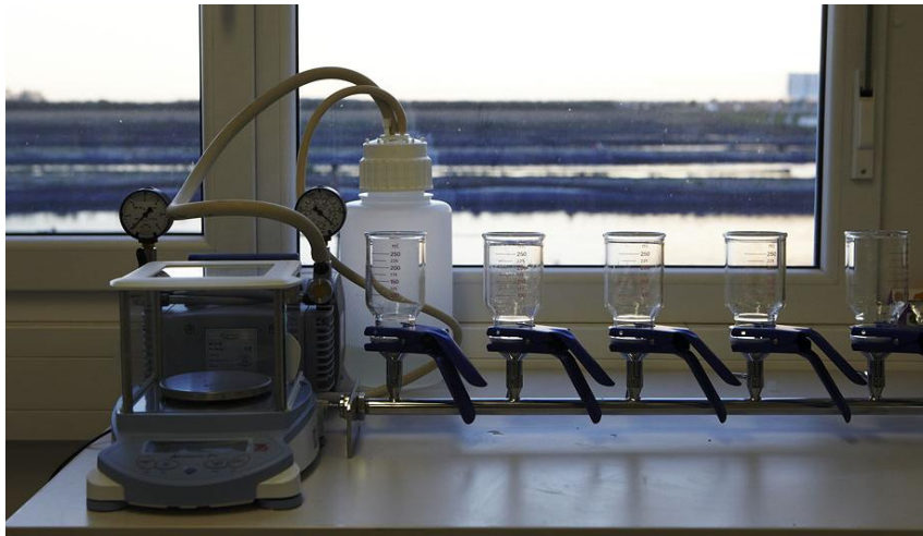
Figuur 20. Filtratieopstelling en een balans in de port cabine. (Foto: Wolter en Dros)
