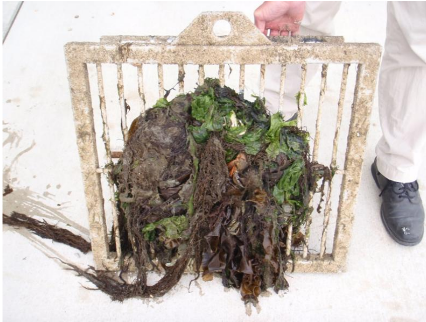
Figuur 5. Dichtslibbing van het rooster voor de innamebuis.
