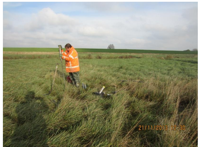
Foto 2: Prepareren Eijkelkamp steekbus op de schor
