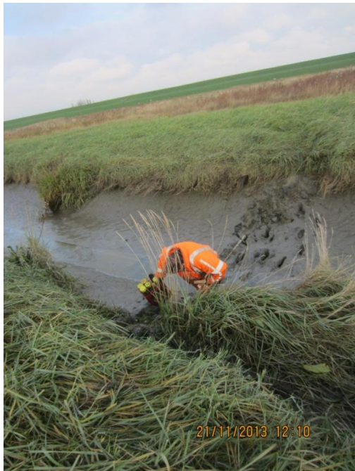
Foto 2: Prepareren Eijkelkamp steekbus op de schor
