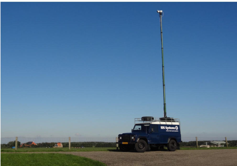
Figuur 5.1 IR-systeem op meetvoertuig
