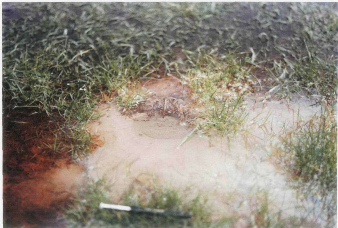
2.13b: Kleine zandmeevoerende wel op maaiveld, langs de IJsseldijk nabij Wilp. [RWS-DWW 197/15a]
