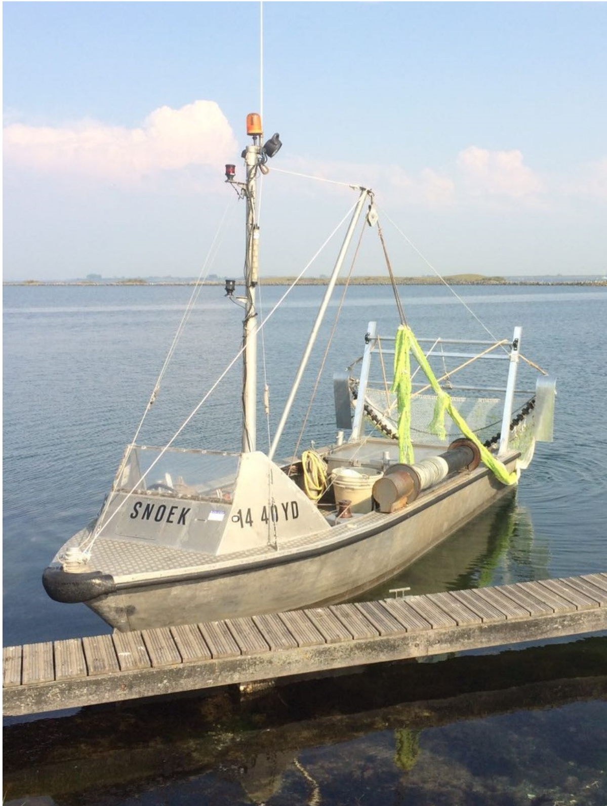
Afbeelding 2.1. Onderzoeksboot op het Grevelingenmeer, met aan de achterzijde de boomkor (3 m).
