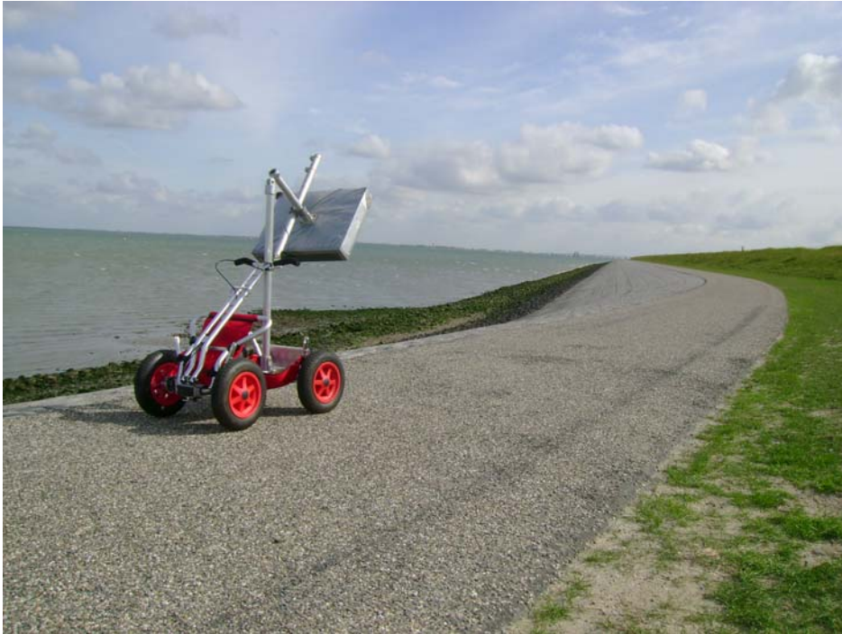
Figuur 1: De Mobiele L-band microgolven scanner van Miramap op de dijk bij Colijnsplaat
