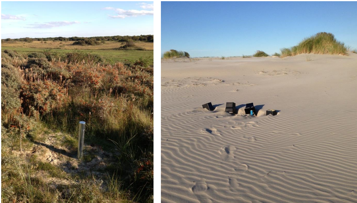
FIG. 4.17. De belangrijkste peilbuizen in het studiegebied: PB.5 in de lijzijde van de stuifdijk (links) en PB.3 in het embryonale duingebied (rechts). Door winderosie worden de straatpotjes voortdurend losgewoeld (vervanging door diepe kokers is gewenst). Foto's door auteur.
