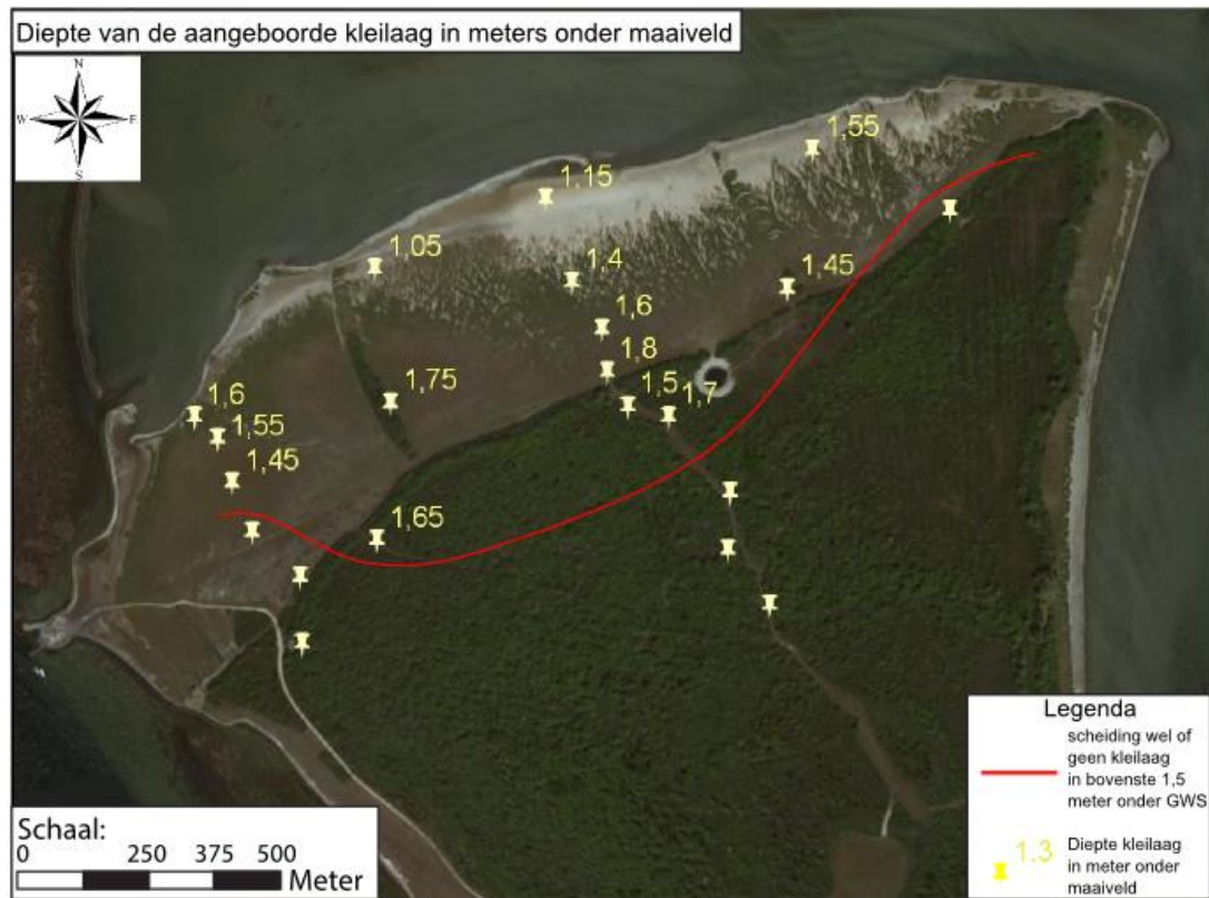
FIG. 6.5. Kaart met de diepteligging van een kleilaag per meetpunt in de bovenste 1,5 meter onder de grondwaterstand. Naar Van Loon (2013).
