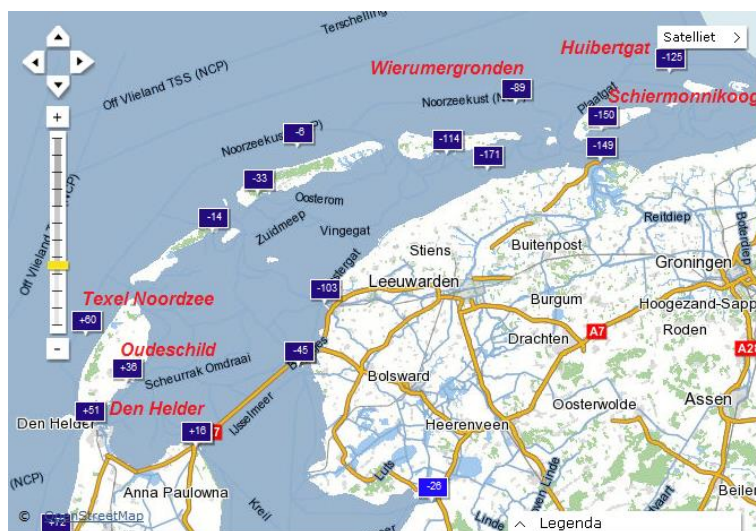
FIG. 4.8. Meest relevante RWS-meetpunten van de zeewaterstand voor Schiermonnikoog: Wierumergronden en Huibertgat aan Noordzee-zijde en Schiermonnikoog aan de Wad-zijde. De getoonde meetwaarden in cm+NAP zijn een momentopname op 20 November 2013.
