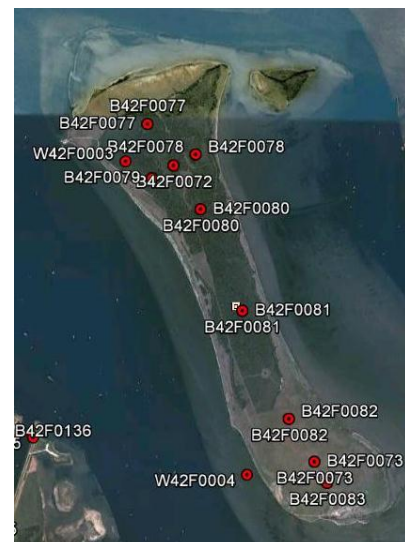
FIG. 6.17. Verticale chloride-profielen op 9 meetpunten op de Veermansplaat in 1993-1994. Gebaseerd op data verkregen van Dinoloket. Kengetallen van de ligging van het zoet-zout grensvlak op de 9 meetlocaties zijn gebaseerd op deze diepteprofielen en vermeld in Tabel 6.3.
