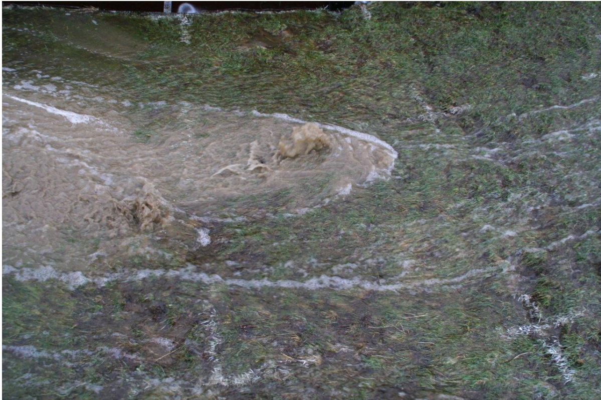
Figuur B89. Tholen. Sectie 3, afrastering. Zandmeevoerende wellen.
