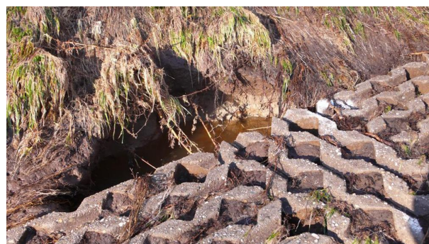
Figuur 8.5 Schade aan teen na 30 l/s per m (Golfoverslagproeven Boonweg, Fryslân)
