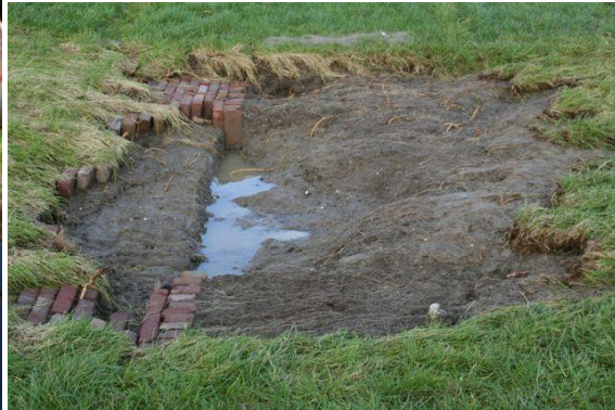
Foto B9. Boonweg. Sectie 1. Na de proef, geen schade aan het talud wel aan de teen
