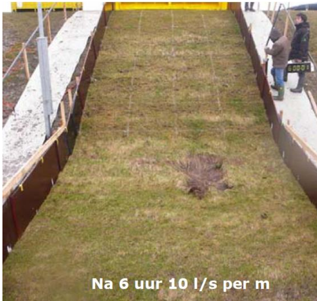
Foto B26. Afsluitdijk. Sectie 1. Begin van schade aan teen.
