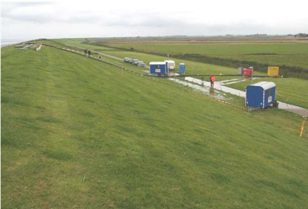
Figuur 4.9 Opstelling afschuifproef met een 30 m lange buis op de kruin van de dijk (Friese Waddenzeedijk nabij de Boonweg)
