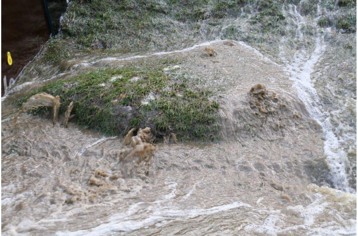
Figuur B90. Tholen. Sectie 3, afrastering. Opbolmechanisme. Bol wordt gevuld door zand.
