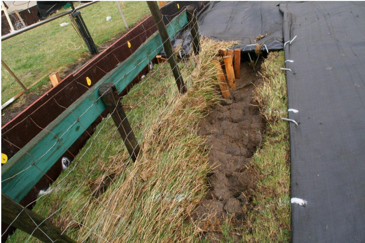
Figuur B92. Tholen. Sectie 3, afrastering. Geen schade aan afrastering door aflopend water.
