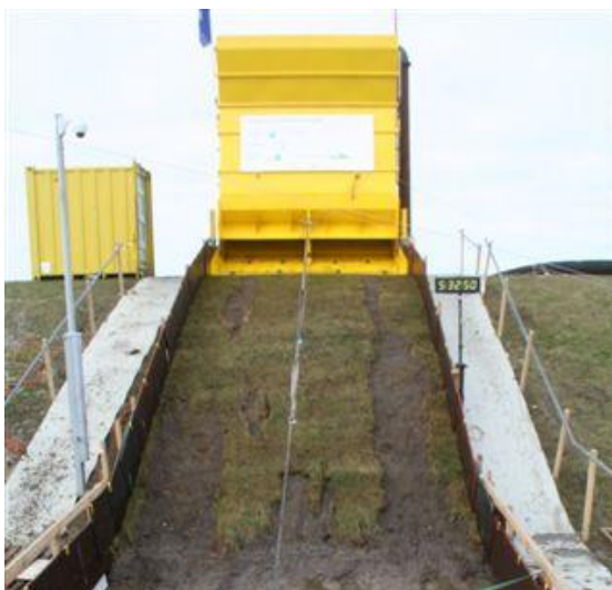
Figuur 2.3 Golfoverslagproef Afsluitdijk. Vroegtijdig afstropen van gras, maar een zeer erosiebestendige toplaag.
