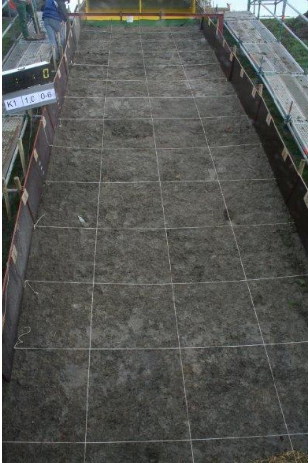
Foto B1. Delfzijl. Kale klei. Vooraf met kleine beschadigingen in het midden.
