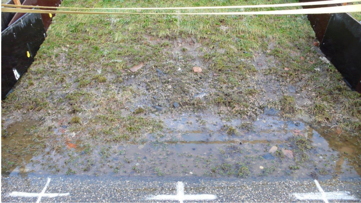
Figuur B104. Tholen, sectie A, oploop buitentalud. Na Ru_{2\%} op 0,8 m boven bermniveau.
