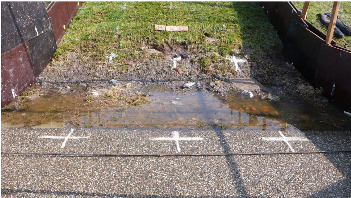
Figuur B105. Tholen, sectie A, oploop buitentalud. Na Ru_{2\%} op 1,6 m boven bermniveau.
