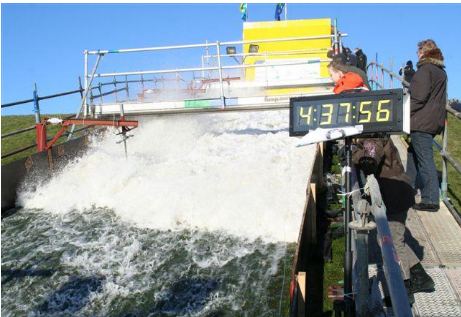
Figuur 4.5 De golfoverslagsimulator die een volume loslaat van 5,5 \text{ m}^3/\text{m} .
