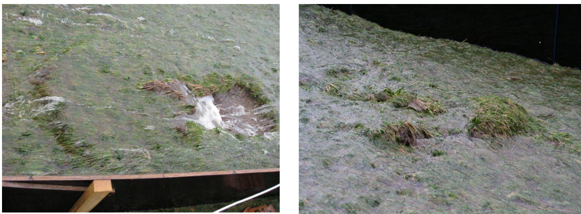
Figuur 5.2 Opbolmechanismen (golfoverslagproeven op Waddenzeedijk Friesland bij de Boonweg)
