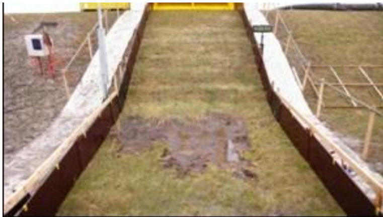
Figuur 8.5 Schade aan teen na 30 l/s per m (Golfoverslagproeven Boonweg, Fryslân)
