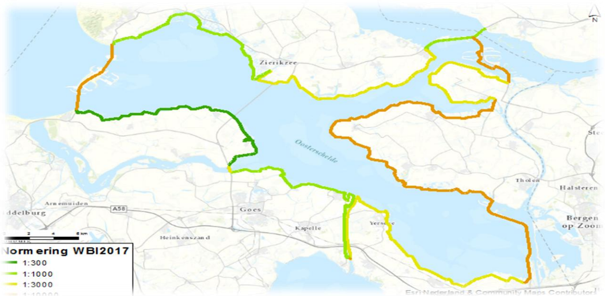
Afbeelding 4.2 Normering dijktrajecten langs de Oosterschelde
