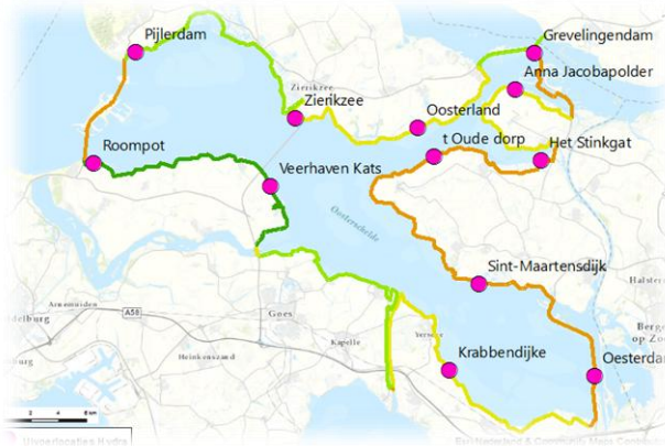
Afbeelding 4.3 Toegepaste uitvoerlocaties bepaling hydraulische belastingen
