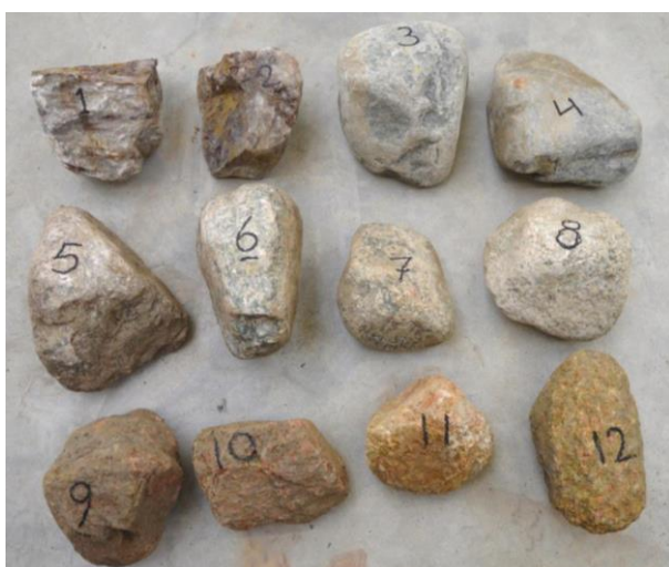
Figuur 3.9 De soortelijke massa van de vlinten is bepaald van 12 stenen, die op basis van uiterlijk representatief zijn voor de range aan kleuren en structuren van de gebruikte stenen in de modelopstelling.
