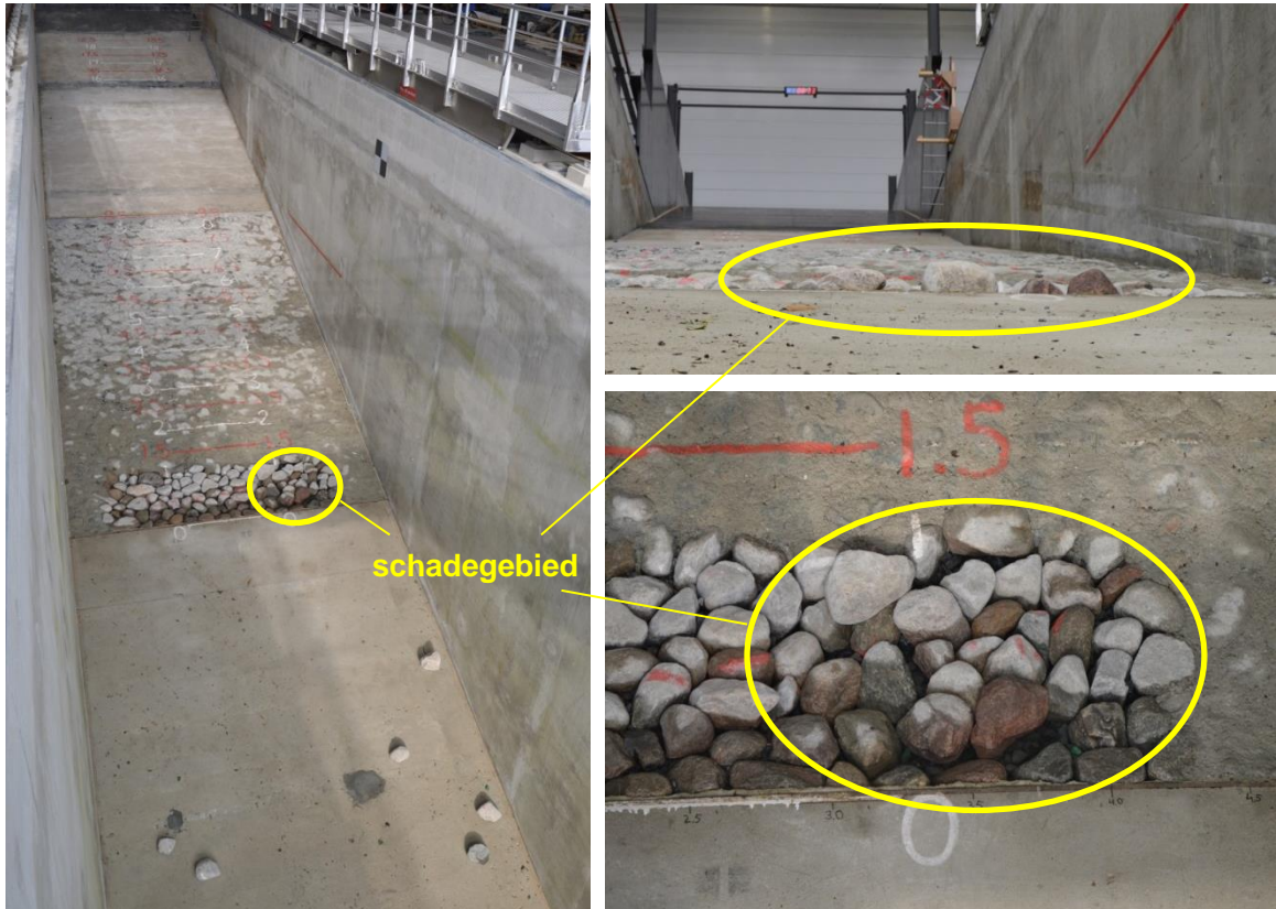
Figuur 6.5 Circa 1 uur en 2 minuten na het begin van proef N09 sloeg een steen uit het niet-ingegoten deel van de testsectie. In de daarop volgende minuut rolden nog zes stenen uit het talud.
