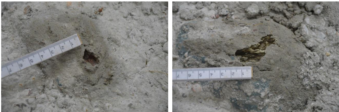
Figuur 6.1 Na proef N01 bleek dat op twee plaatsen een klein stukje van een vlint was afgebroken. Links: het gat bij [x' = 6,85 m; Y = 2,0] . Rechts: het gat bij [x' = 8,25 m; Y = 1,3] .
