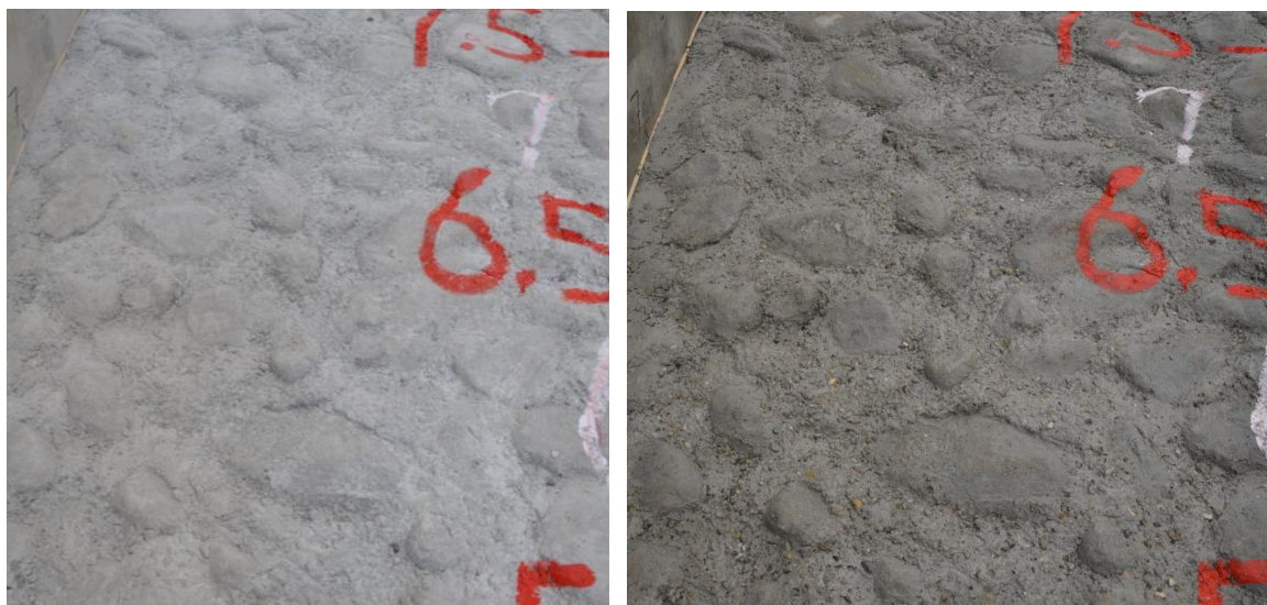
Figuur 6.2 In de loop van de proeven is het betonoppervlak tussen de vlinten enigszins gesleten. Links: voor proef N01. Rechts: na proef N05.
