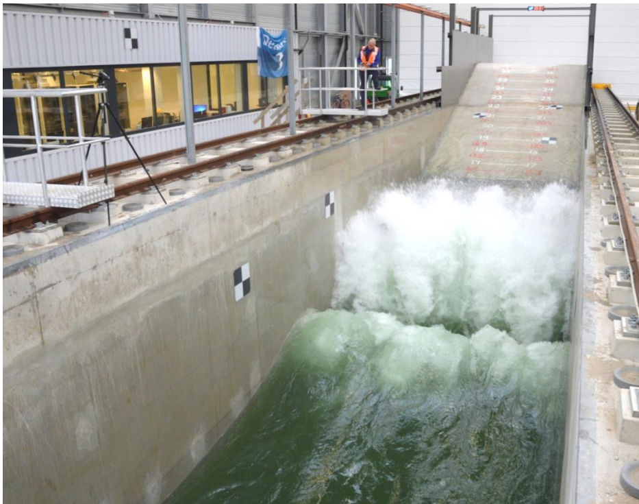
Figuur 2.1 Golfaanval op met beton ingegoten Noorse steen in de Deltagoot.
