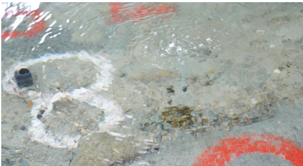
Figuur 6.4 Uit het gat in de vliet bij [x' = 8,25 \text{ m}; Y = 1,3] komen luchtbelletjes omhoog tijdens het verhogen van de waterstand.
