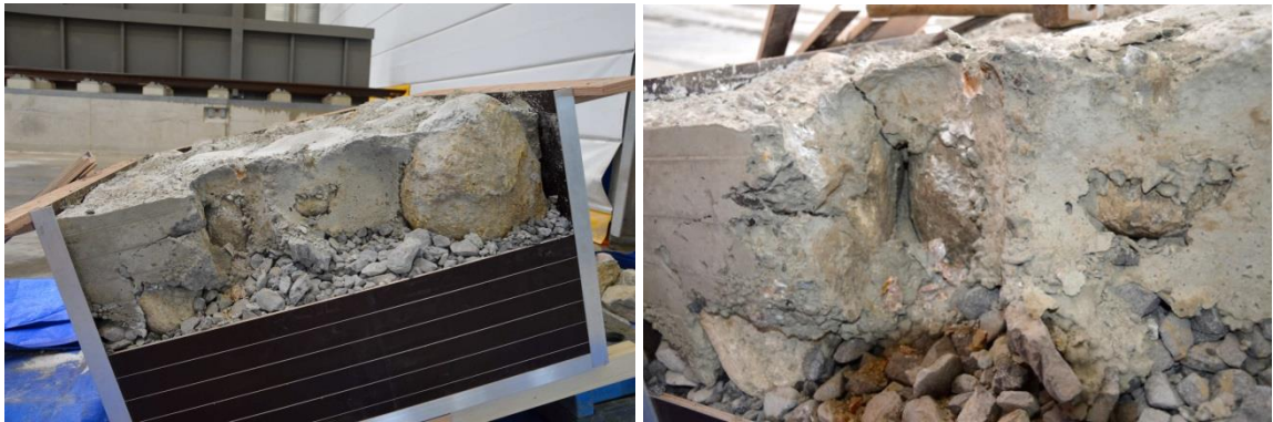
Figuur 7.4 Opgebroken proefstuk van ingegoten Noorse steen.
