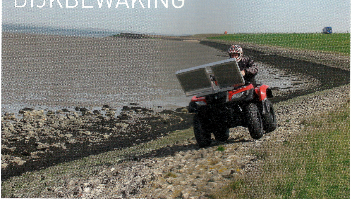
Bij Kattendijke (Zeeland) heeft Rijkswaterstaat de microgolven scanner gemonteerd op een quad
