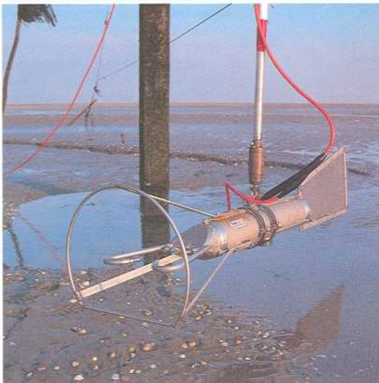
Foto 6. De akoestische zandtransportmeter; dit apparaat kan de stroomsnelheid, de stroomrichting, de zandconcentratie en de waterdiepte tegelijkertijd, momentaan meten.
