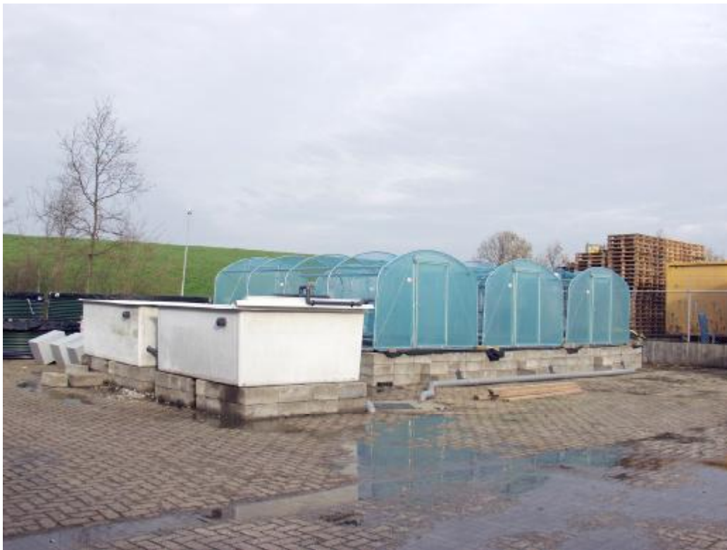
Experimentele set-up met rechts de drie recirculatievijvers en links de twee filter bakken.
