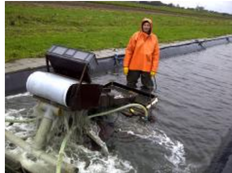
Oogst met aangepaste zageroogstmachine
