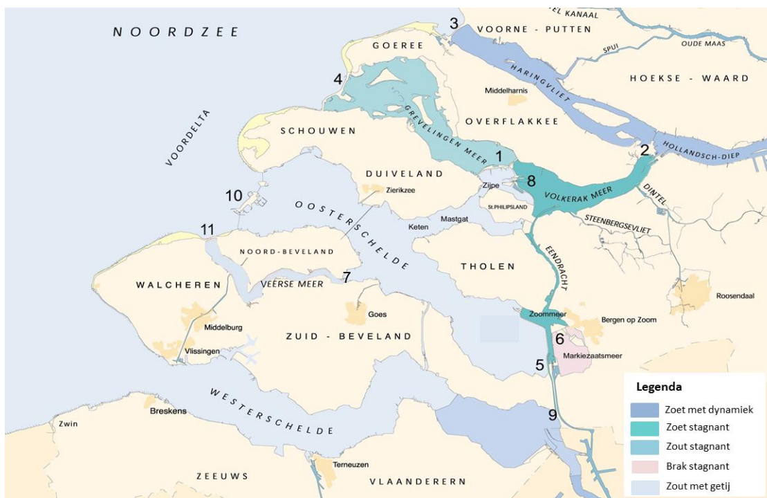
Figuur 2. De bekken van de Zuidwestelijke Delta en Deltawerken: 1. Grevelingendam, 2. Volkerakdam, 3. Haringvlietsluizen, 4. Brouwersdam, 5. Oesterdam, 6. Markiezaatkade, 7. Zandkreekdam, 8. Philipsdam, 9. Bathse Spuisluis, 10. Oosterscheldekering, 11. Veerse Gatdam.
