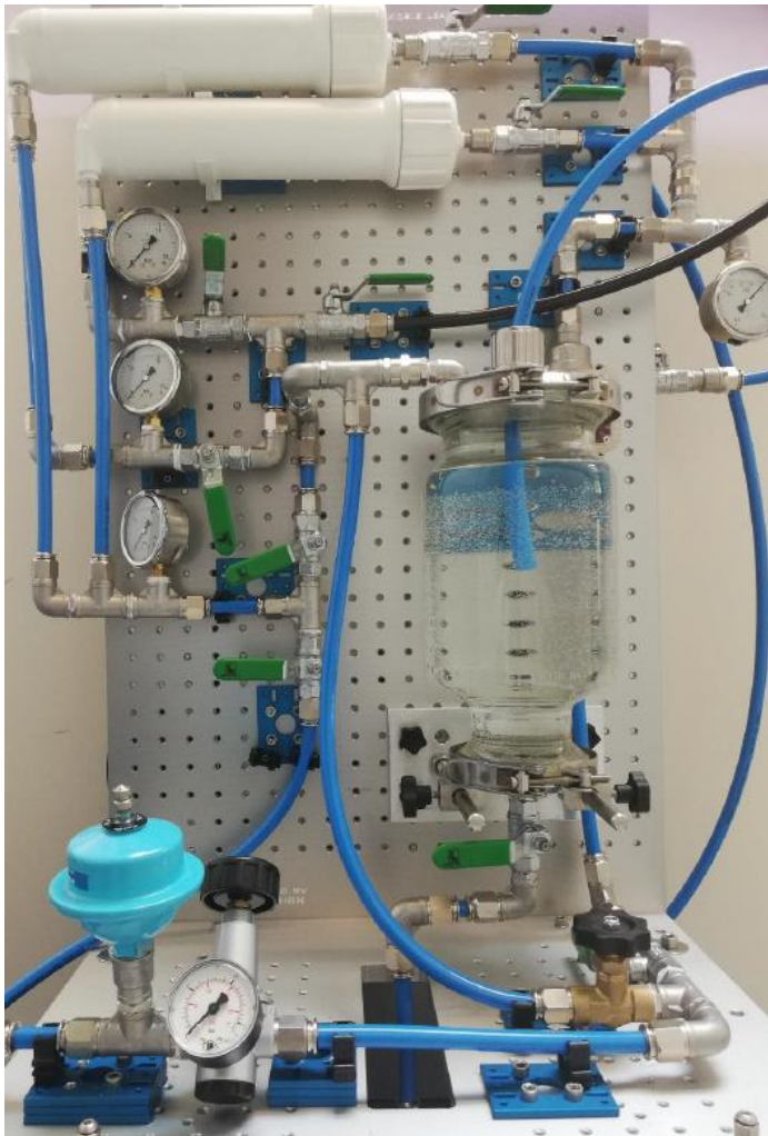
Figuur 2 - Omgekeerde osmose systeem (close-up)
