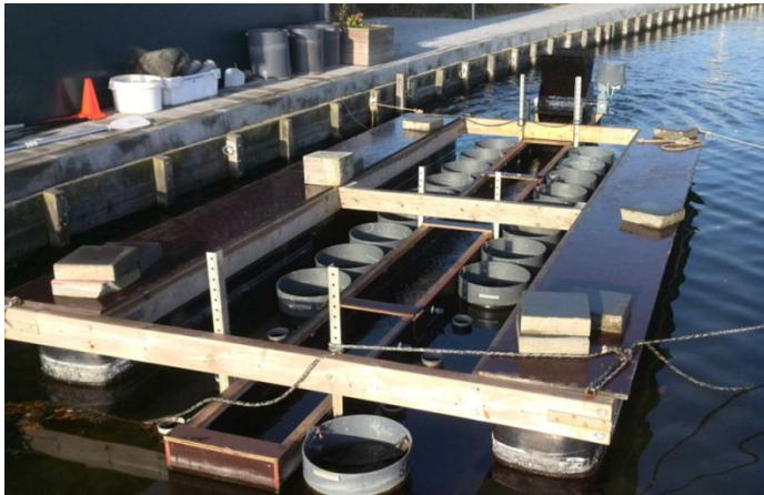
Fig. 2.5. Het FLoating UPwelling System van Roem van Yerseke bij Oesterhaven (foto Wouter Bareman).
