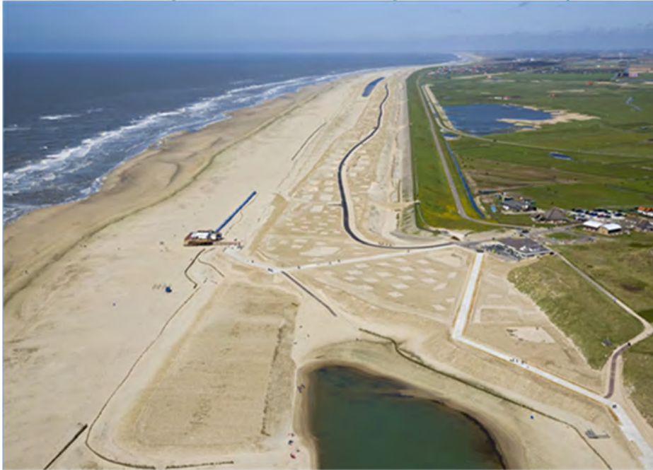
Afbeelding 2.6: Zandige versterking van de HD met de ontwerpelementen: helminplant, luwe laagtes (dat zijn de niet-ingeplante vakken), wilgenschermen en in de verte de vochtige duinvallei. (Foto: www.hoogwaterbeschermingsprogramma.nl ).
