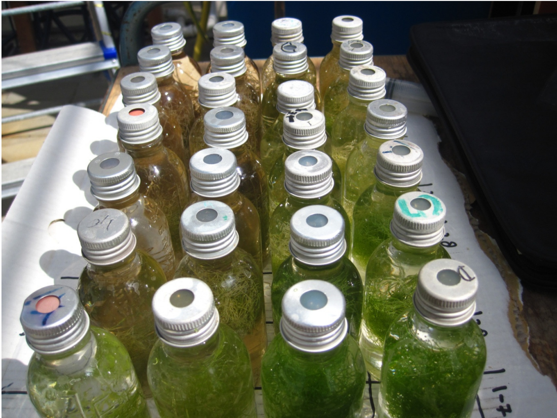
Figuur 28: foto van alle afgesloten flesjes met wier tijdens de uitdrogings experiment. Achterin staan de langst gedroogde plukken, voorin het wier dat niet gedroogd is. Duidelijk te zien is hoe het gedroogde wier een theekleur afgeeft aan het water waarin het zich bevindt.
