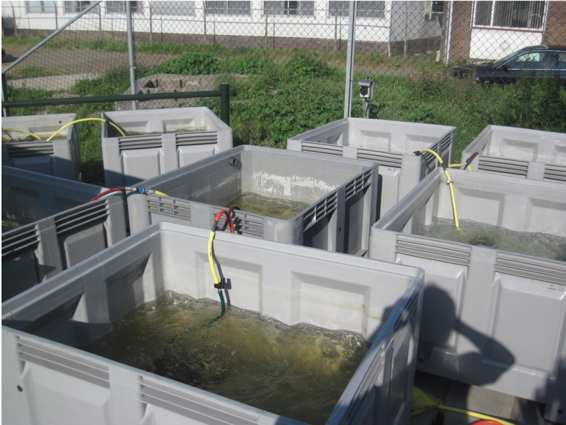
Figuur 9: foto van de gebruikte onderzoeksopzet van het nutriëntenexperiment: zes open, beluchte bakken.
