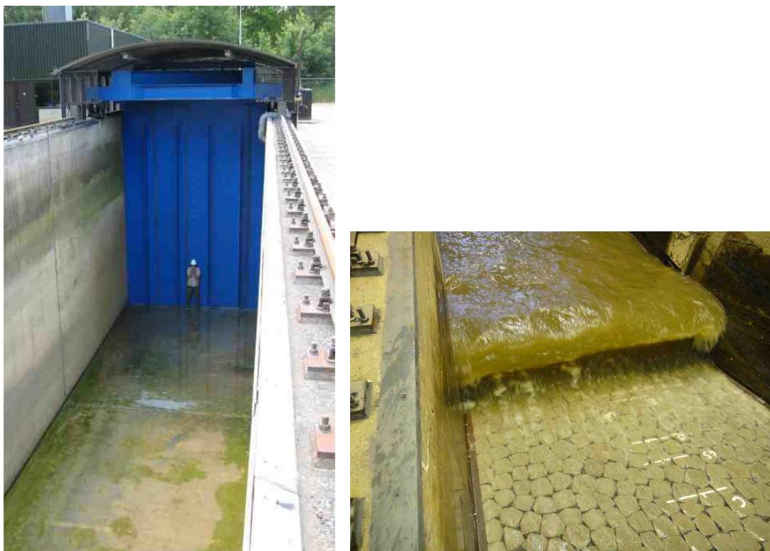
Figuur 3.1 Modelonderzoek in de Deltagoot tijdens proef 6 (rechts) en golfschot (links)
