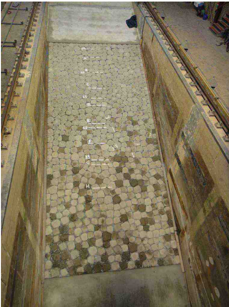
b) Hersteld profiel (voor proef 2)
