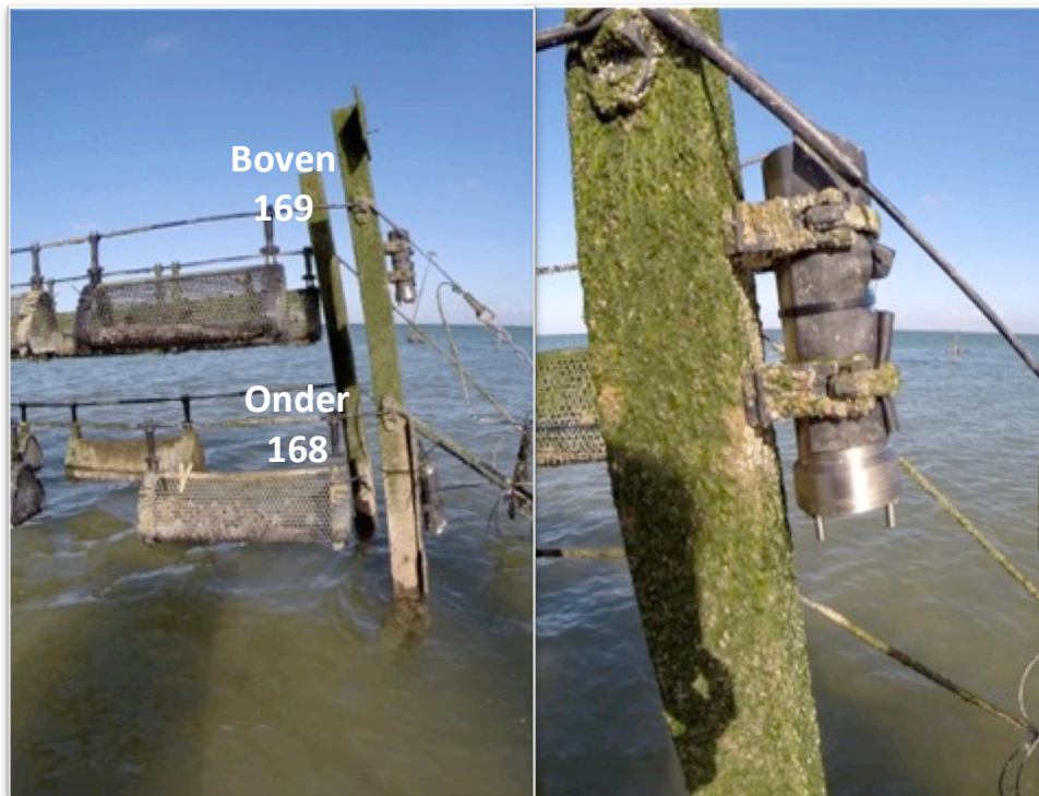
Afbeelding 12: Opstelling van de fluorescentiemeters op de kweeklocatie bij Kattendijke, ter hoogte van de bovenste en onderste lijn mandjes met een verschillende droogvalduur (Capelle & Hartog, 2014).
