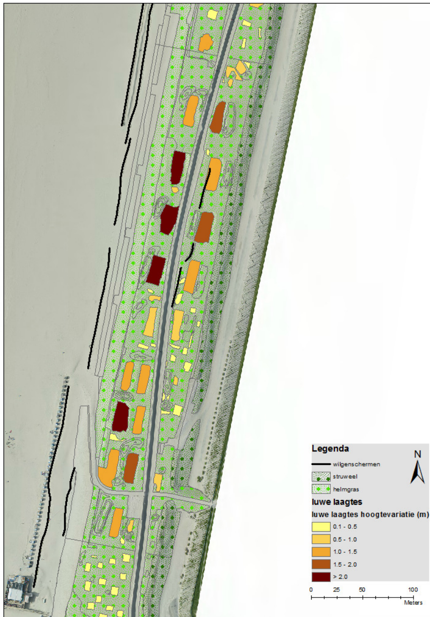
Figuur 4-3: Maatregelen helmbeplanting, luwe laagten en wilgenschermen aanlegsituatie, december 2015. Profieltype 2, RSP 25.40 – 25.89.
