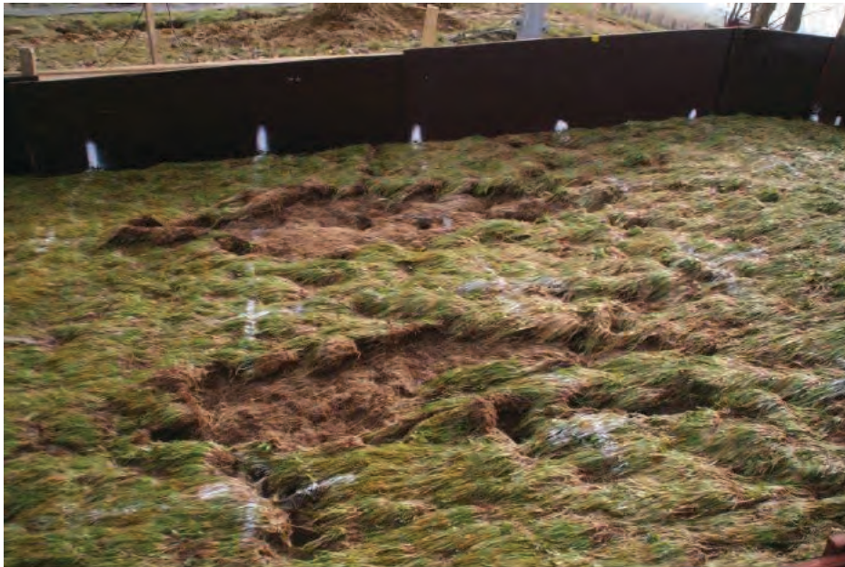
Figuur 61 Overslagproef vechtdijk - Eindresultaat overslagproef (Meer, 2012)
