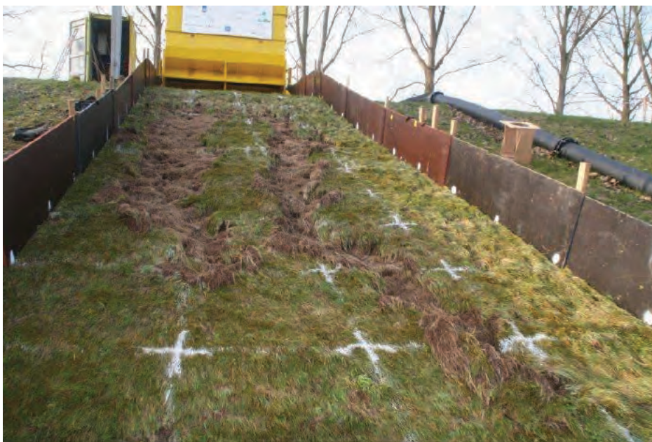
Figuur 62 Overslagproef vechtdijk - Eindresultaat overslagproef (Meer, 2012)
