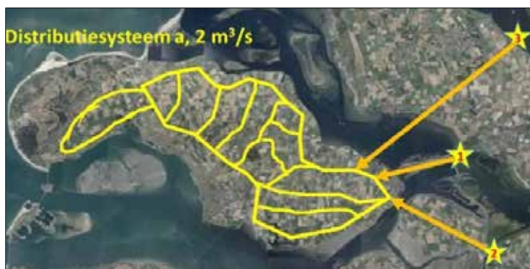
Figuur 13 a (links) en b (rechts). Overzicht van de beschouwde aanvoeropties met de bronnen (1) Noorder Krammer, (2) Eendracht en (3) Haringvliet, in combinatie met een gesloten distributieringsysteem (a) en een open doorvoersysteem (b).
