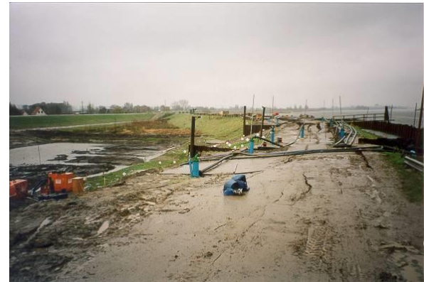
Figuur B.5 Links: Dwarsdoorsnede Bergambachtproef en locatie hellingmeetbuis HBM6; Rechts: foto impressie, N.B. op de foto is de rivier aan de rechterzijde
