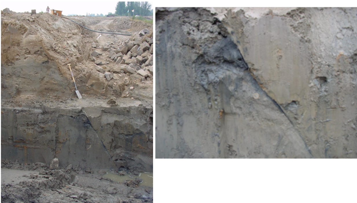
Figuur B.8 Lokalisatie van verplaatsingen en vervormingen rondom het glijvlak
