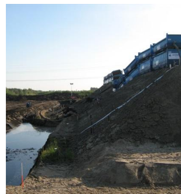
Figuur B.1 Gerealiseerde afschuiving, links bovenaanzicht het gearceerde deel geeft de afschuiving weer. Uit Zwanenburg e.a. 2012; rechts, foto zijaanzicht
