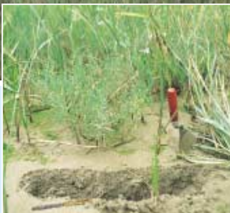
Foto 28 De "vooroeversuppletie" bij het Konijnenschor (Saeftinge) In de geul vóór het Konijnenschor (Westerschelde) is tot 1997 jaarlijks ca. 3 miljoen m 3 zand gestort in verband met het vaargeulonderhoud. Een deel van dit zand is op het slik afgezet en het slik is opgehoogd. Dit heeft geleid tot een redelijk unieke situatie: ondanks de erosie van de laagwaterlijn (uitbochten geul) heeft het schor zich kunnen uitbreiden. De schorbodem bestaat vlakbij de rand uit vrijwel puur zand (foto-inzet).
