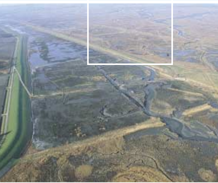
Foto 31 Spontane ontpoldering in de Westerschelde: het Sieperdaschor. Deze foto is genomen in een periode dat de morfologische ontwikkeling in het Sieperdaschor in een stroomversnelling raakten. Na de aanleg van een bredere brug (voorjaar 1993) werd de wateruitwisseling tussen het schor en de Westerschelde sterk verbeterd. Als gevolg van de toegenomen getijenergie schuurden de krekken sneller uit. De drainage van het schor verbeterde en de gebieden die langdurig onder water stonden (linksboven op de foto) namen in omvang af.
