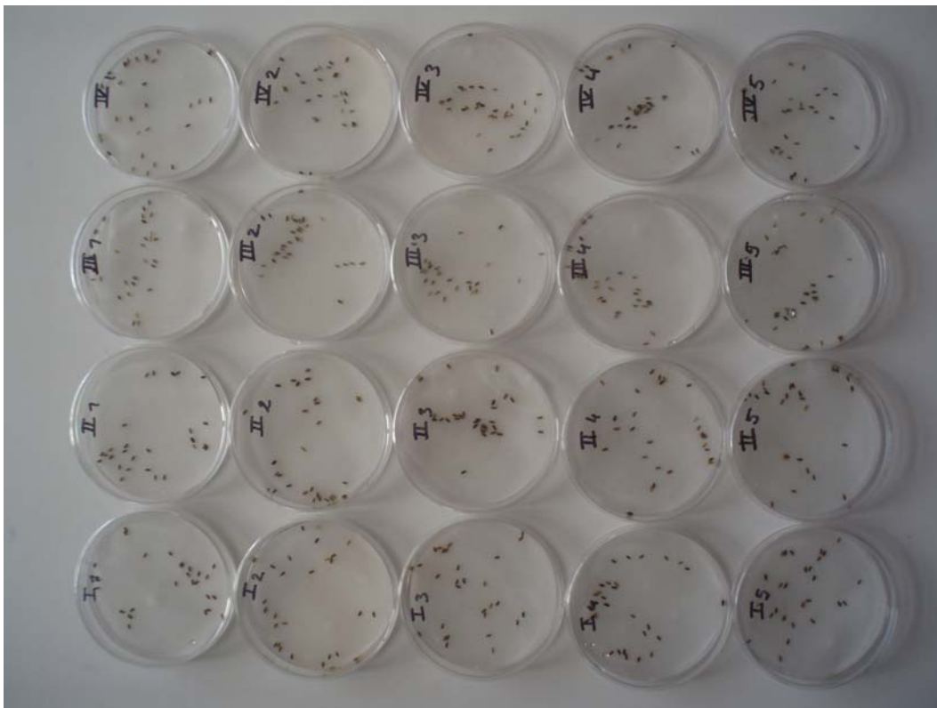
Foto 2. Overzicht petrischalen voor testen kiemingspercentages
