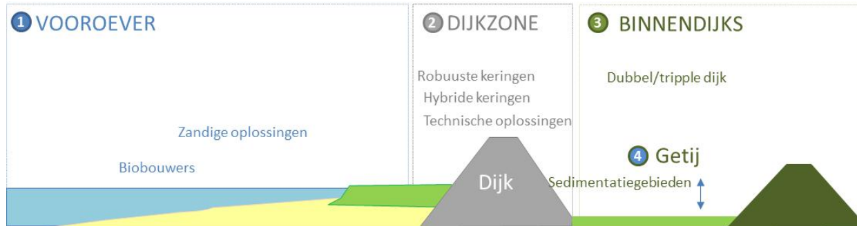
Figuur 5, ruimtelijke indeling voor toepassing van innovatieve dijkconcepten op de vooroever (buitendijks), in de dijkzone, binnendijks of binnendijks met toelating van getijde invloed.
