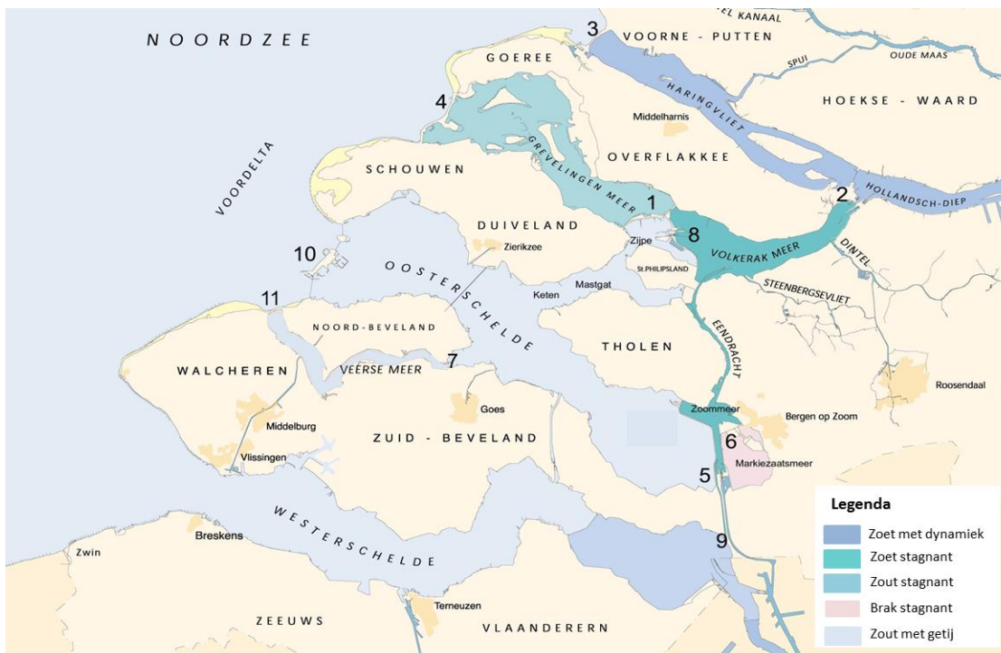
Figuur 1: de bekken van de Zuidwestelijke Delta en Deltawerken: 1. Grevelingendam, 2. Volkerakdam, 3. Haringvlietsluizen, 4. Brouwersdam, 5. Oesterdam, 6. Markiezaatkade, 7. Zandkreekdam, 8. Philipsdam, 9. Bathse Spuisluis, 10. Oosterscheldekering, 11. Veerse Gatdam.
