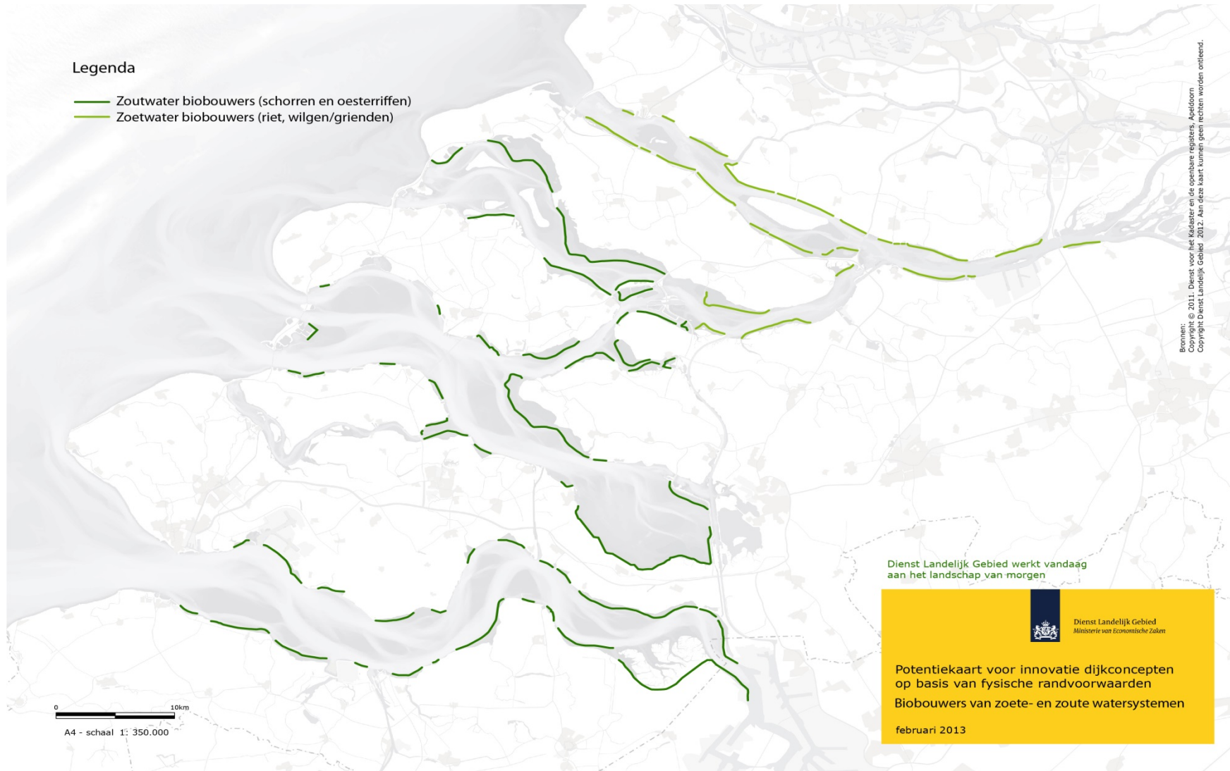
Figuur 9, Verbeelding van de mogelijkheden voor innovatieve dijkconcepten op basis van de fysische randvoorwaarden (zoutgehalte, getij, sediment voorradigheid) in de Zuidwestelijke Delta (uitgaande van de huidige situatie: Zoet- en zoutwater biobouwers ).
