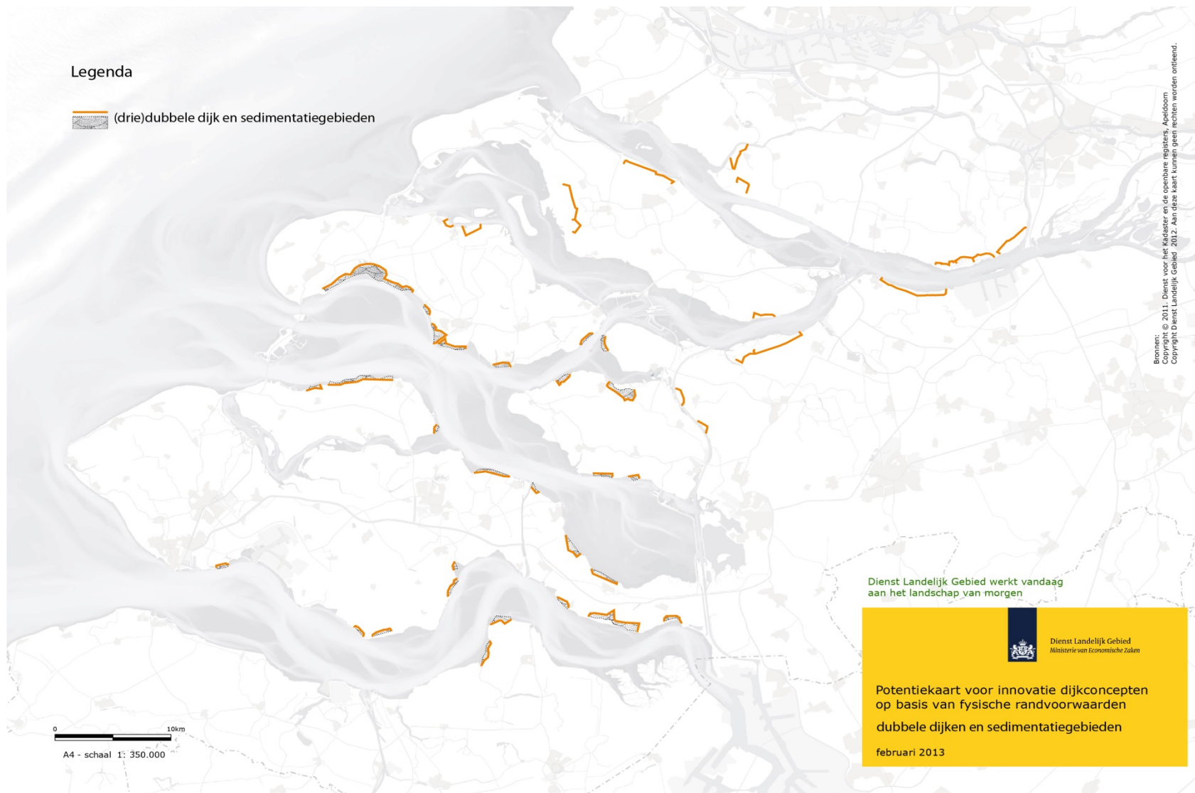
Figuur 11, Verbeelding van de mogelijkheden voor innovatieve dijkconcepten op basis van de fysische randvoorwaarden (zoutgehalte, getij, sediment voorradigheid) in de Zuidwestelijke Delta (uitgaande van de huidige situatie: Dubbel/tripple dijken en Sedimentatiegebieden ).
