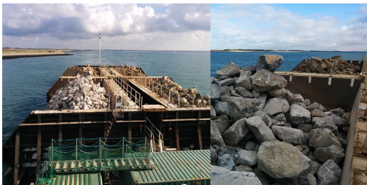
Figuur 8. De gevulde zijstorter op weg naar de Schelphoek. In de bakken bij de steven zit de bruinkleurige zandsteen; in de andere bakken de grijskleurige breuksteen (Bron: De Vries en van de Wiel)
