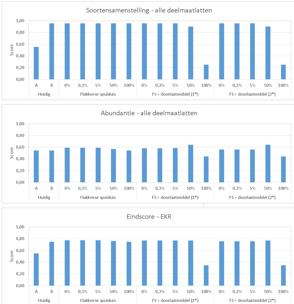
Figuur 5.3. Score soortensamenstelling en abundantie alle deelmaatlatten en eindscore. Bij huidige visstand is gebruik gemaakt van beschikbare gegevens (A), evenals gegevens waarbij deze zijn aangevuld met de soorten zoals deze op de Oosterschelde voorkomen (B). Bij 1 is uitgegaan van een toename van alle vissoorten met 30% a.g.v. het vergrote doorlaatmiddel, bij 2 is uitgegaan van een toename van 30% van de standvissen en een toename van 60% van de vissen die niet hun gehele levenscyclus in het Grevelingenmeer verblijven.
