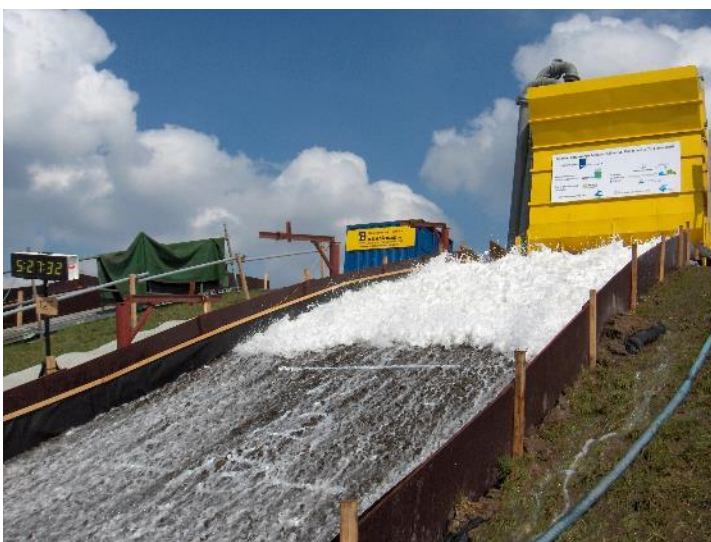
Figuur 9. Overslagtest door Infram te Kattendijke (foto: Bijlsma, 2008).
