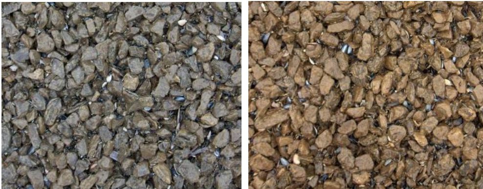
Afbeelding 1. Links: optimale situatie. Rechts: typische verkleuring als gevolg van gebruik natte stenen in mengsel.
