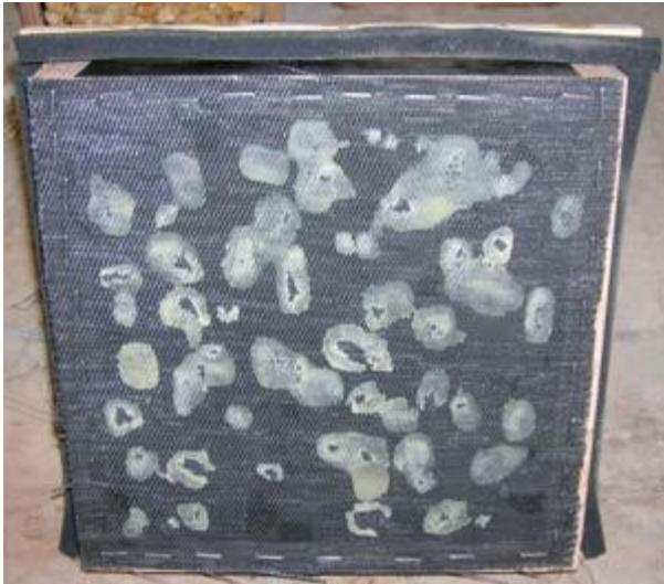
Figuur 16. Onderzijde proefstuk met PBA aangebracht op een geotextiel (bron: Gu, 2007).
