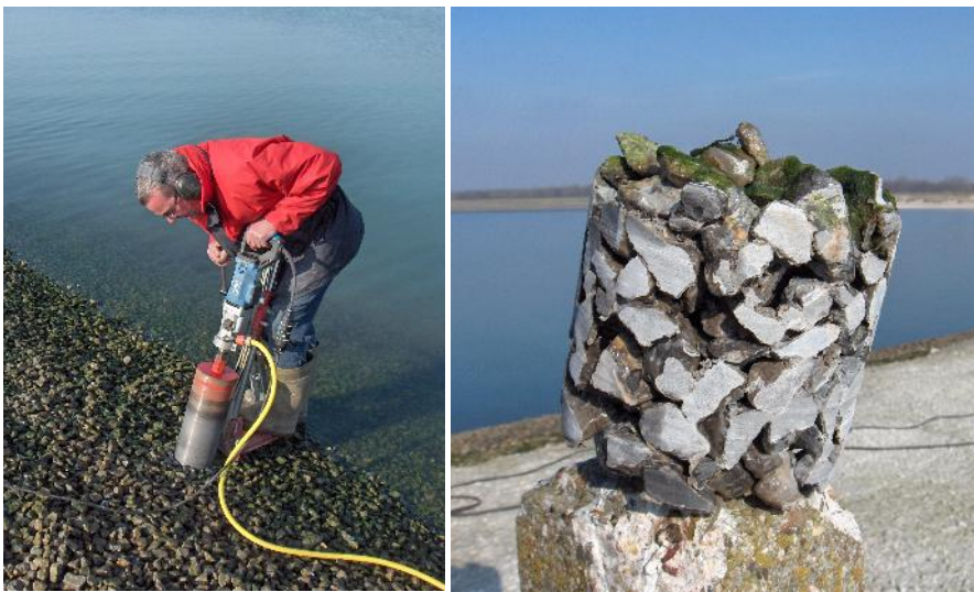
Figuur 6. Uitvoeren kernboring op polyurethaan gebonden bekleding (links) en boorkern (rechts) (foto: Bijlsma, 2008).
