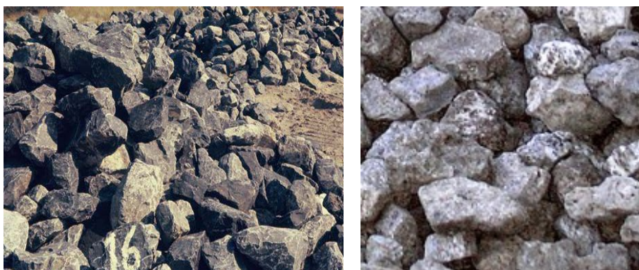
Figuur 1. Links: breuksteen (bron: RWS Beeldbank), rechts: LD-staalslakken (bron: www.dehoop-bouwgrondstoffen.nl )
