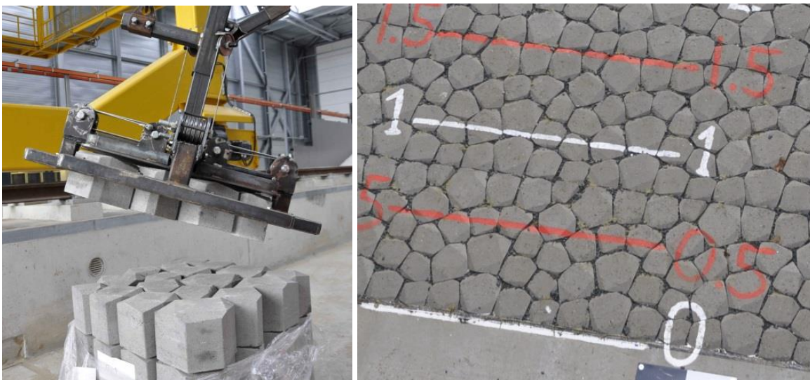
Figuur 2.2 Basalton+ 30 STS van Holcim Coastal BV (links: klem voor mechanisch zetten in de Deltagoot)
