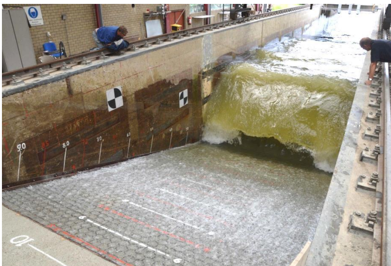
Figuur 1.1 Stabiliteitsproeven met RONA ® ton in de Deltagoot in de Noordoostpolder
