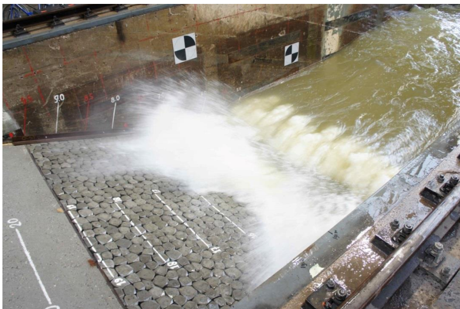
Figuur A.1 Golfaanval op testsectie van Basalton.
