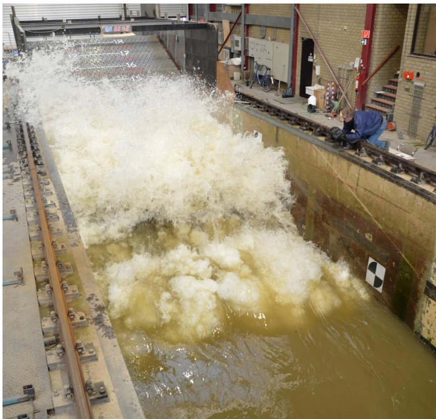
Figuur 2.15 Golfaanval op Verkalit® GOR in de Deltagoot in de Noordoostpolder
