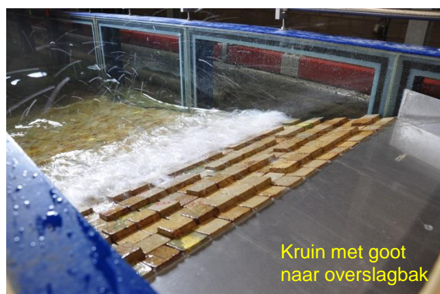
Figuur 3.4 Ribbenpatroon (foto en tekening van bovenaanzicht waarin de ribben rood zijn gekleurd)
