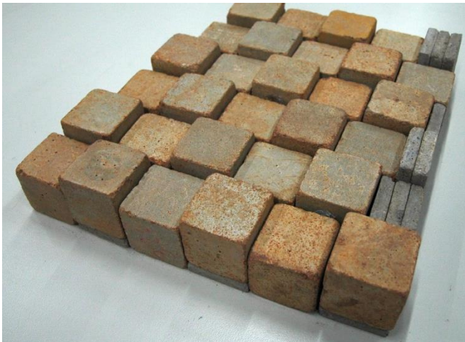
Figuur 3.2: Schematisering van steenzetting in dambordpatroon met kubussen van 5 \times 5 \times 5 \text{ cm}^3
