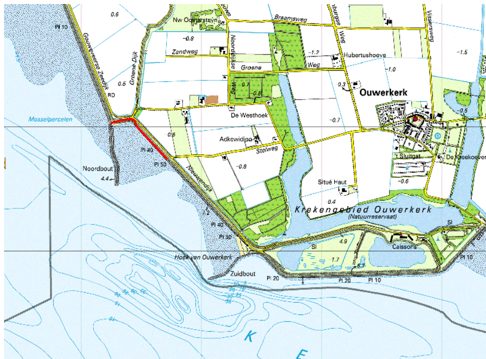
Figuur 7-2 Kust bij Ouwerkerk met een tweetal nollen (hier genaamd Noordbout en Zuidbout), waar tegen aanzanding heeft plaatsgevonden. Het met rood aangegeven dijkgedeelte ligt beschut bij westelijke winden t.g.v. de Noordbout. Indien deze Noordbout bestand is tegen 1/4000 ste stormcondities kan het golfreducerende effect van deze nol worden verdisconteerd in de golfcondities van het met rood aangegeven traject
