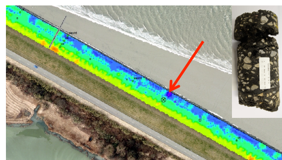
Structuurvariaties in het asfalt en boorkern
