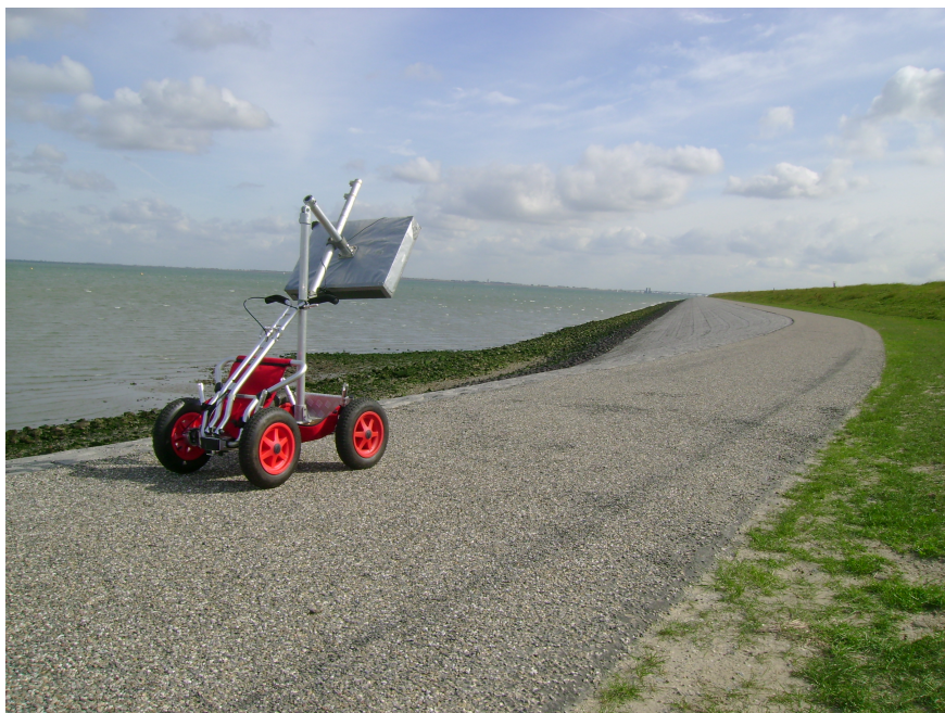
Figuur 1: De Mobiele L-band microgolven scanner van Miramap op de dijk bij Colijnsplaat (Zeeland)
