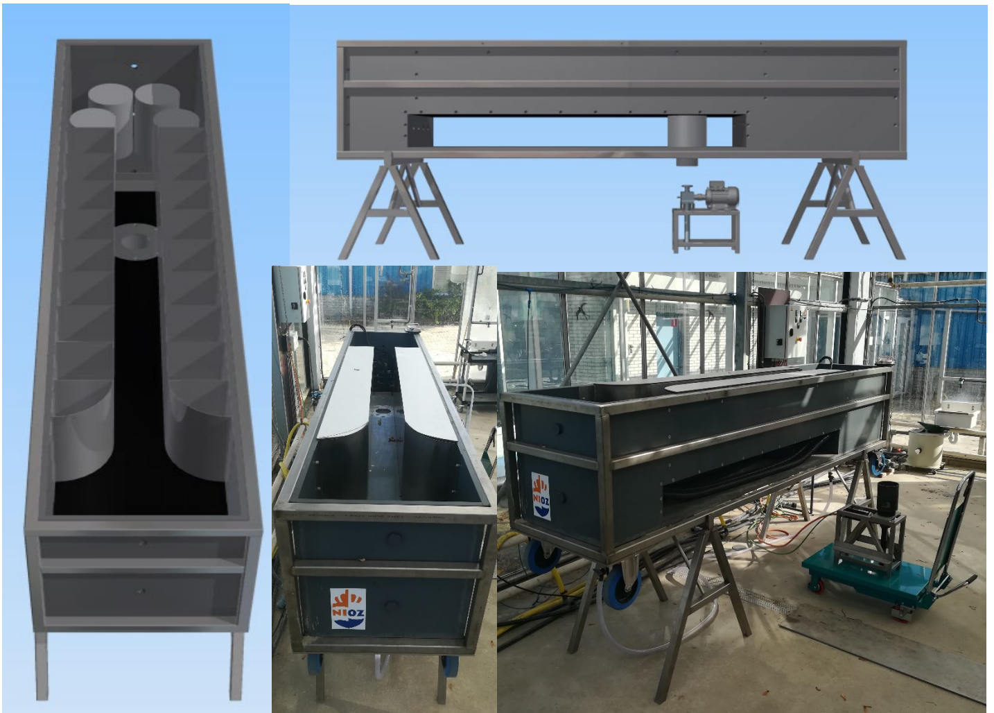
Figuur 93. Nieuwe stroomgoot genaamd Stormy (Flume) voor geconditioneerde experimenten, hierbij worden verschillende erosiesnelheden tijdens stormen nagebootst.
