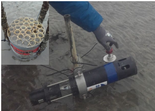
Figuur 86. OBS en sediment val
