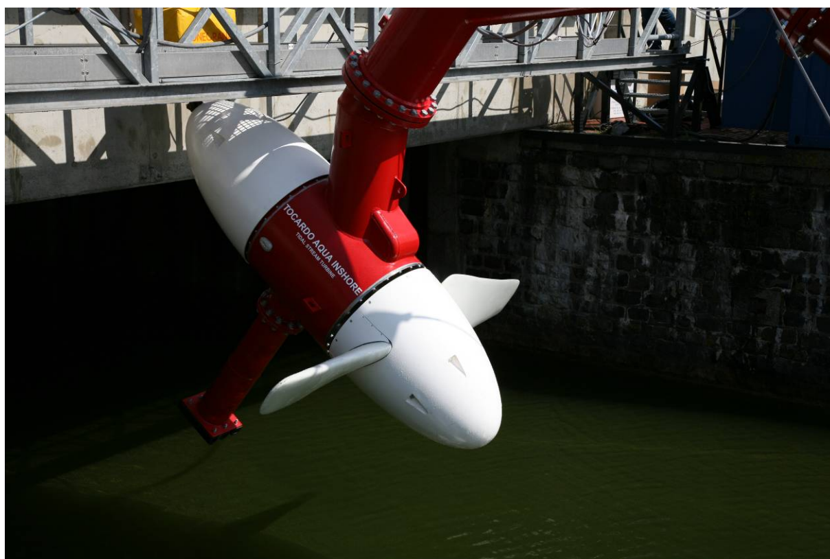
Fig. 2. Tocardo turbine zoals geplaatst in de Afsluitdijk bij Den Oever. In de Oosterscheldekering worden vergelijkbare turbines geplaatst maar met een andere omwentelingssnelheid.
