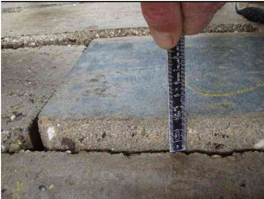
b) Blokbeweging na Proef 17a (rij Y)
