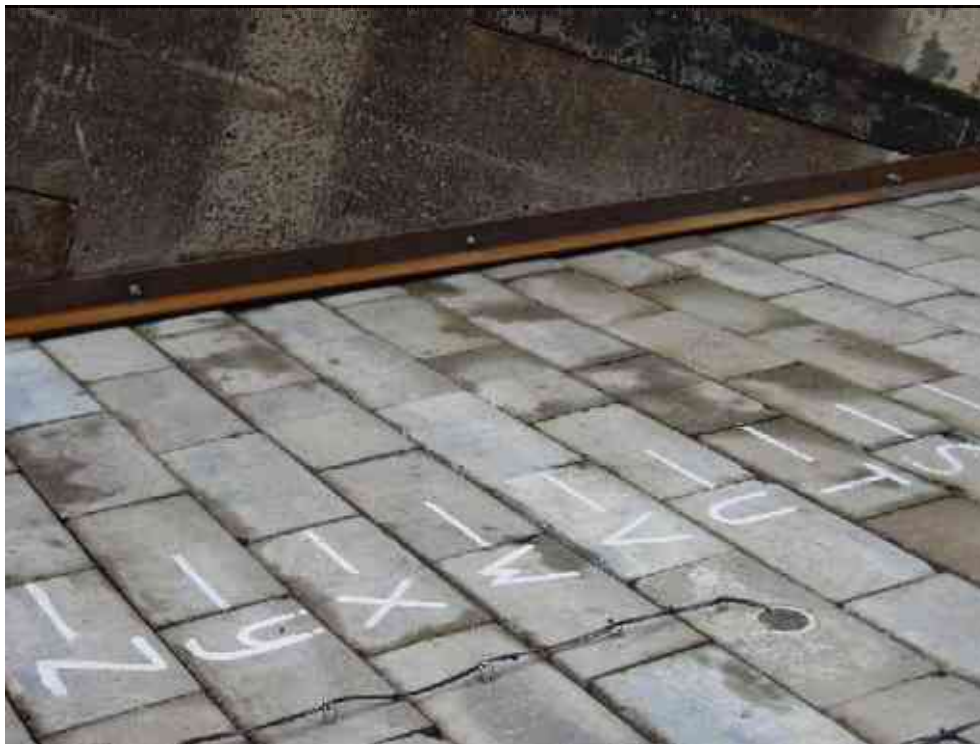
b) Gezakte bloklaag na Proef 13 (rij X-S, +3,55m tot +3,95m)
