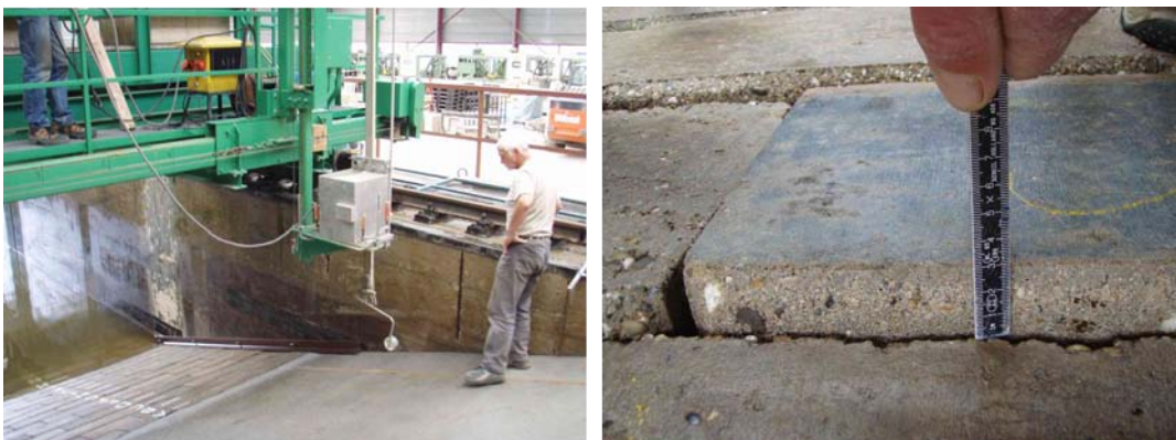
Figuur 8 Links: inmeten van taludoppervlak, rechts: blokbeweging na proef 17a (blokrij Y)
