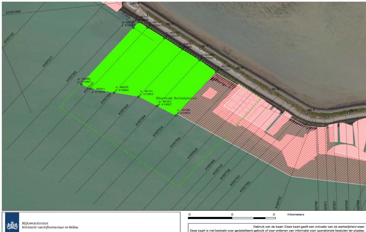
Figuur 5. Vooroeverbestedingen op de Oostelijke strekdam bij Schelphoek. Op het met groen aangegeven deel is de Building for Nature-vooroeverbesteding met de ecologische toplaag van breuksteen (kalksteen en zandsteen) uitgevoerd. In het roze gearceerde gebied liggen eerdere bestorvingen met staalslakken die zijn uitgevoerd in 2010; vooroeverbestedingen staan met egaal roze aangeduid (Bron: Rijkswaterstaat).
