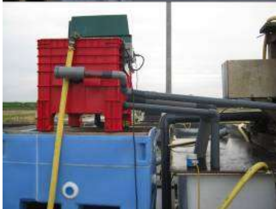
Links boven het 10 mm filtergas in het voorfilter. Rechtsboven en linksonder de filteropstelling. Rechtsonder het trommelfilter gemaakt van een oude kokkelmolen.
