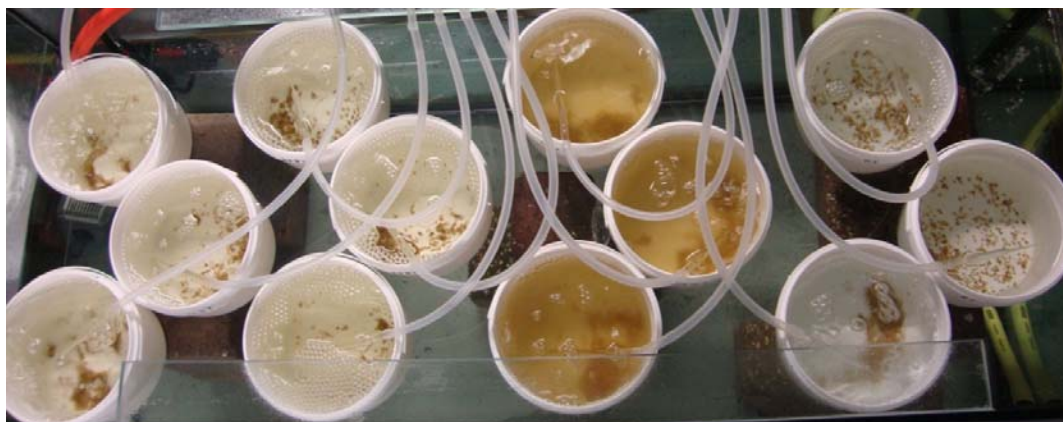
Figuur 5 Proefopzet bioassay schelpdieren (tapijtschelpenbroed). De tweede serie van rechts filtreert niet, en kan daardoor in dit water niet overleven.
