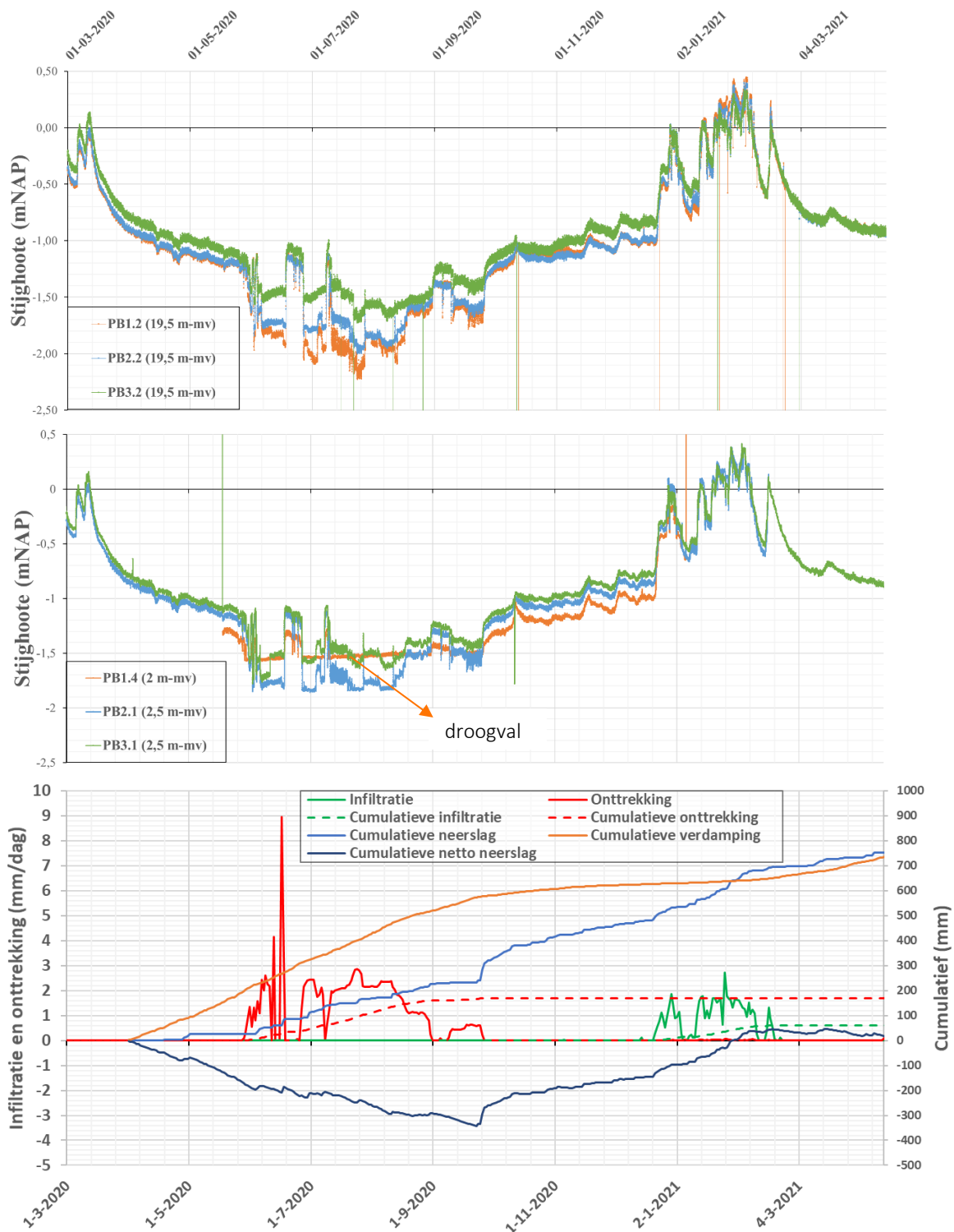
Figuur 4-1: Boven: stijghoogtes die gemeten en gelogd zijn met de CTD-loggers in het watervoerend pakket (PB1.2, PB2.2 en PB3.2). Midden: stijghoogtes die gemeten en gelogd zijn met de TD-loggers in de ondiepe waarnemingsputten (PB1.4, PB2.1, PB3.1). De logger in PB1.4 heeft op verschillende momenten tijdens de onttrekking droog gestaan, waardoor de stijghoogtereeks relatief vlak loopt op respectievelijk ca. -1.56 mNAP. Onder: meetreeksen van infiltratie en onttrekking (omgerekend van m 3 /dag naar mm/dag met het perceeloppervlak van 25 ha, en infiltratie, onttrekking, neerslag, verdamping en netto neerslag gegeven als cumulatief volume in mm vanaf 1 april 2020.
