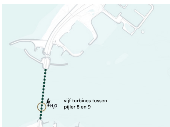
Getijdenenergie als proef opstelling tussen pijler 8 en 9
