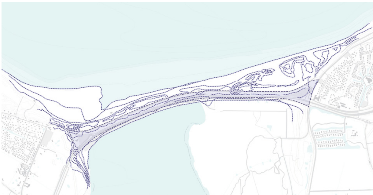
Verduining van de dam volgens natuurlijk proces, helpt tevens scheuren in het asfalt tegen te gaan
