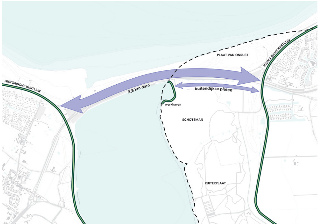
Uitgangssituatie , dam tussen twee oude kustlijnen en half op de Plaat van Onrust waarin de werkhaven wordt aangelegd
