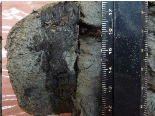
Type 6. Boring T03, monster 102EA (563-578 cm –mv). Zware zavel; silt- en kleilaagjes 0,2-0,7 cm dik; plantenresten. Organisch stofgehalte ca. 4,5%. Rechts slijtvlak op niet nader gedetermineerde plantenrest.
