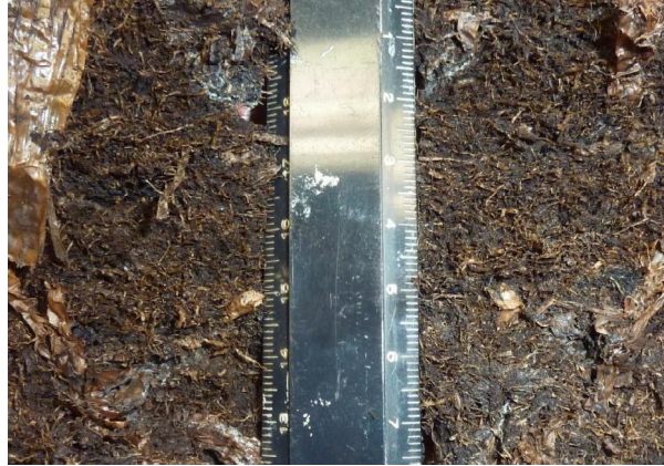
Type 4. Boring B10d, monster 55DA (346-361 cm –mv). “Zeggeveen” (worteltjesveen) met enig riet. Organisch stofgehalte ca. 90%.
