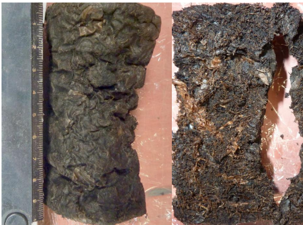
Type 4. Boring T02, monster 100A (272-287 cm –mv). Links iets ingedroogd, zo uit het folie (“schrompelveen”), rechts opengesneden zeggeveen met enig riet. Organisch stofgehalte ca. 91%.
