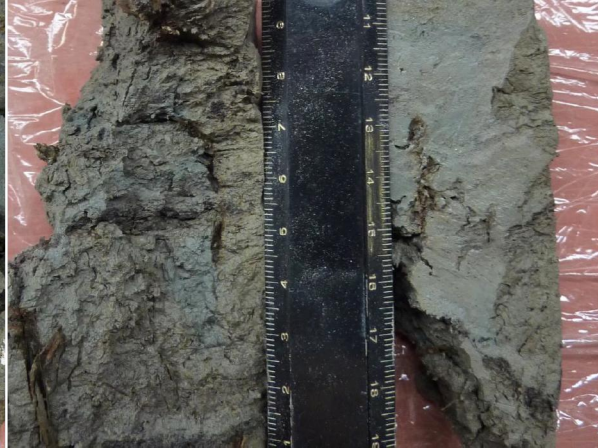
Type 6. Boring T03, monster 103AA (584-599 cm –mv). Lichte klei; zand- en siltlaagjes 0,1-0,5 cm dik. Links opengedoken monster met enige zichtbare plantenresten, rechts gesneden monster. Organisch stofgehalte ca. 5%.
