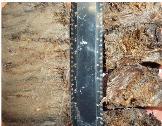
Type 5. Boring 10d, monster 56EA (471-486 cm –mv). Links: links van de liniaal verticaal snijvlak , rechts van de liniaal horizontale splijvlakken . Rechts: verticaal breukvlak . Organisch stofgehalte ca. 18%. Schijn van gelaagdheid op snijvlak door geplette wortelstokken van riet.
