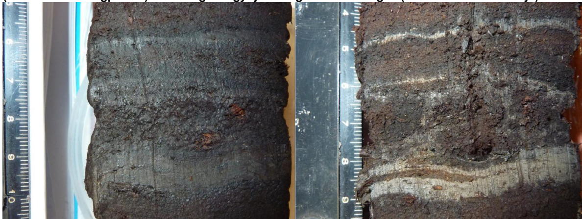
Type 3. Boring 28d, monster 133CA (130-145 cm –mv). Amorf veen met heidehout en varenresten. Kleilaagjes (links in opengesneden monster, rechts na behandeling) met daartussen veenmos. In het opengesneden monster is aan de rechterzijkant het verschil in indrogging van de laagjes met verschillende grondsoort te zien. Organisch stofgehalte ca. 75%.
