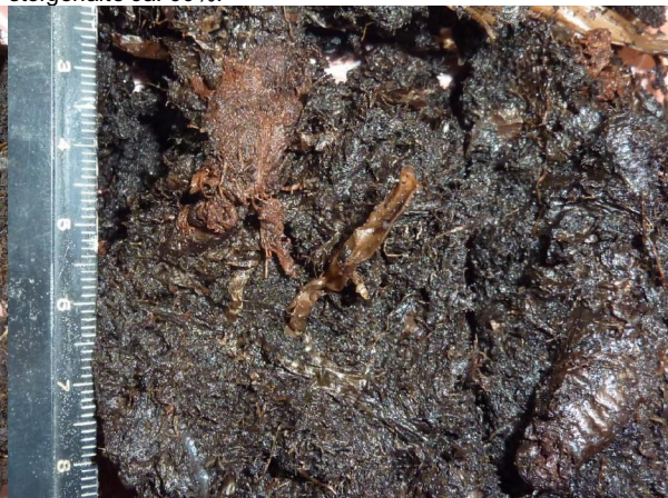
Type 4. Boring T02, monster 99EA (252-267 cm -mv). Stengelbases van Galigaan in “zeggeveen”. Linksboven (aangesneden), rechtsonder in situ . Organisch stofgehalte ca. 89%.
