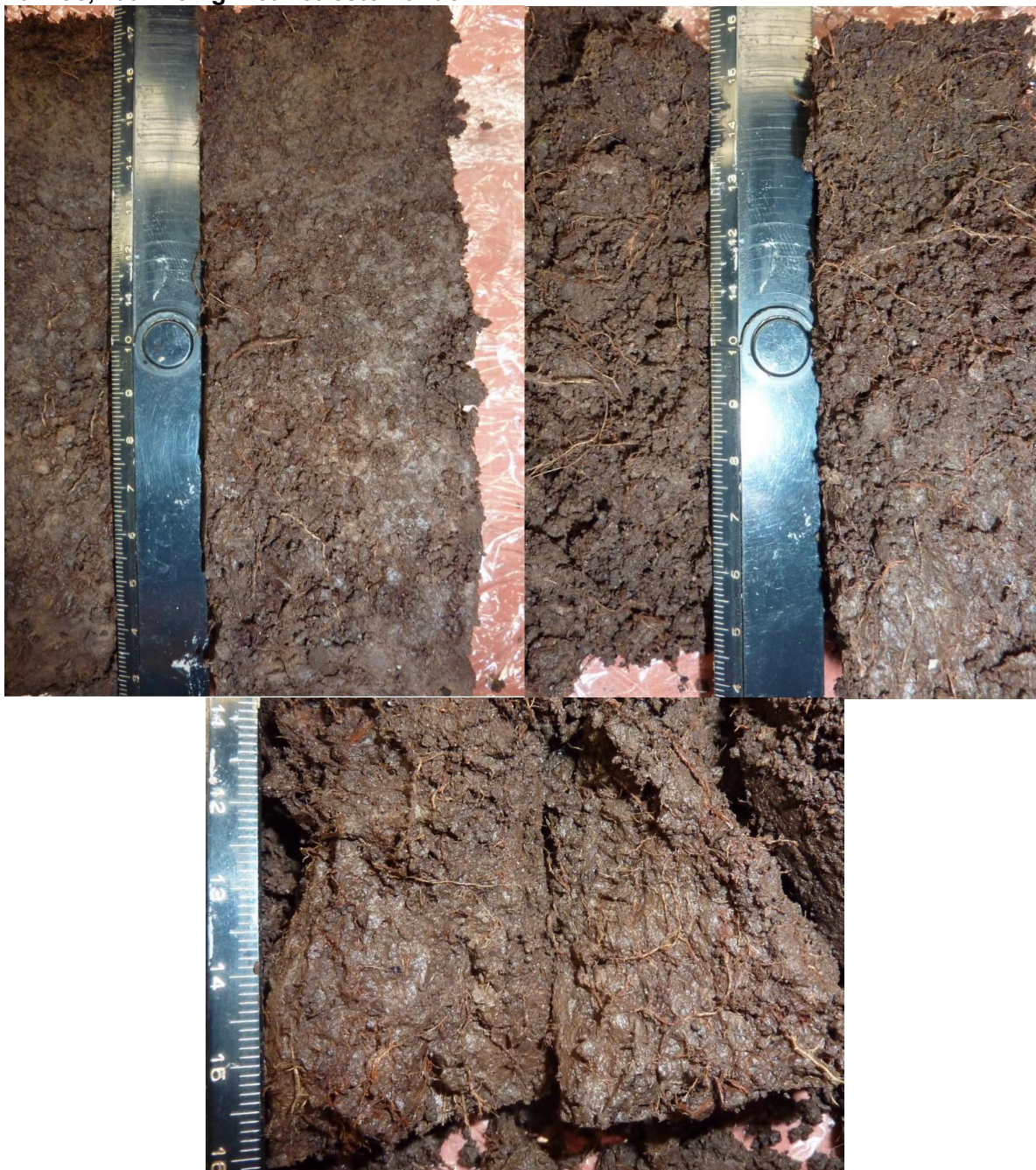
Type 1. Boring 28d, monster 132AA (0-15 cm –mv). Matig zware klei, venig, organisch stofgehalte ca. 39%. Linksboven gesneden, rechtsboven gebroken monster, onder slijtvlak onderzijde. Het monster bevat de wortelzone van het huidige grasland en de bovenzijde van het niveau met rietresten.
