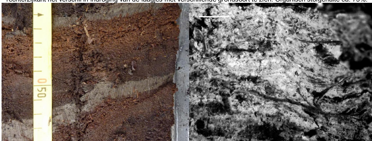
Type 3. Boring 28d, monster 133CA (130-145 cm –mv). Amorf veen met heidehout en varenresten. Kleilaagjes (links in opengesneden monster, rechts na behandeling) met daartussen veenmos. In het opengesneden monster is aan de rechterzijkant het verschil in indrogging van de laagjes met verschillende grondsoort te zien. Organisch stofgehalte ca. 75%.
