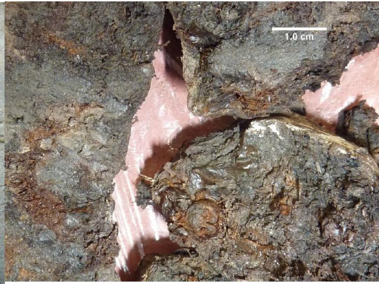
Type 5. Boring 28d, monster 136AB (416-431 cm –mv). Twee verticale en één horizontaal snijvlak (rechtsonder); vooral rietresten, wellicht ook galigaan en (grote) zegge. Organisch stofgehalte ca. 19%.
