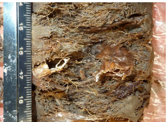
Type 5. Boring 10d, monster 56EA (471-486 cm –mv). Links: links van de liniaal verticaal snijvlak , rechts van de liniaal horizontale splijvlakken . Rechts: verticaal breukvlak . Organisch stofgehalte ca. 18%. Schijn van gelaagdheid op snijvlak door geplette wortelstokken van riet.
