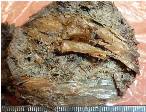
Type 5. Boring 28d, monster 136BA (401-416 cm –mv). Links rietwortelstokken op een horizontaal splijvlak , rechts een verticaal breukvlak . Organisch stofgehalte ca. 18%. Open structuur en wortelcontinuïteit zichtbaar na openbreken.
