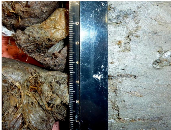
Type 5. Boring 27d, monster 124EA (395-410 cm –mv). Links van de liniaal horizontale splijvlakken , rechts verticaal snijvlak . Organisch stofgehalte ca. 12%.
