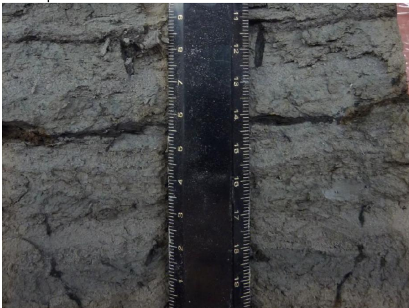
Type 6. Boring T03, monster 102EA (563-578 cm –mv). Zware zavel; silt- en kleilaagjes 0,2-0,7 cm dik; plantenresten. Organisch stofgehalte ca. 4,5%. Rechts slijtvlak op niet nader gedetermineerde plantenrest.
