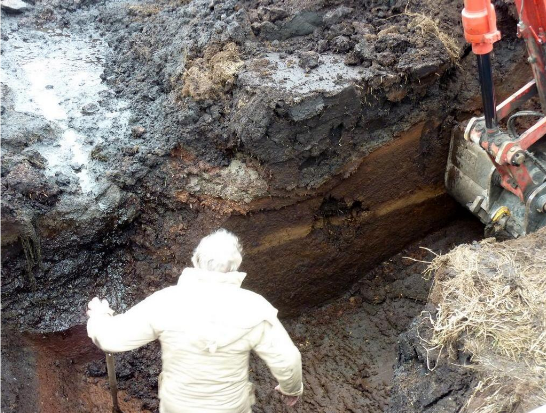
Figuur 2.1 een inspectiesleuf na de bezwijkproef
