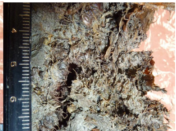
Type 5. Boring 28d, monster 136BA (401-416 cm –mv). Links rietwortelstokken op een horizontaal splijvlak , rechts een verticaal breukvlak . Organisch stofgehalte ca. 18%. Open structuur en wortelcontinuïteit zichtbaar na openbreken.
